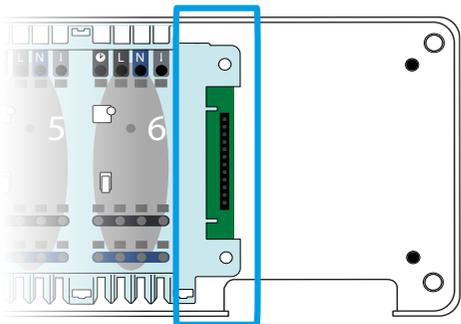
**PL:** Służy do komunikacji pomiędzy listwą KL06, a modulem PL06. Funkcjonalność połączonego zestawu zwiększa się do dodatkowej obsługi pompy lub kotła. Moduł jest zasilany z listwy.
