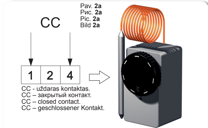
Prieušaliminio termostato patikrinimas. Проверка противозаморающего термостата. Inspection of the antifreeze thermostat. Überprüfung des frostbeständigen Thermostates.
