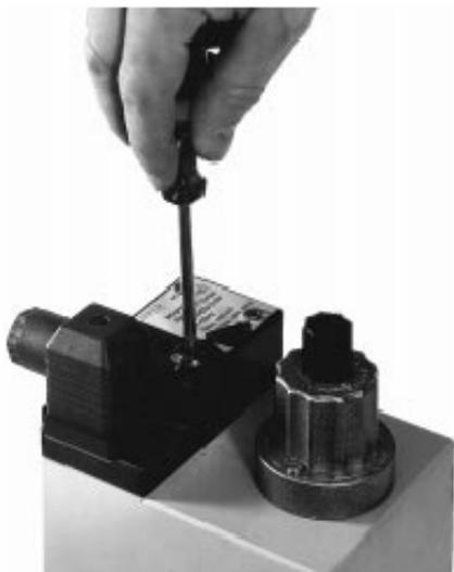
Рис.19 установка давления газа
