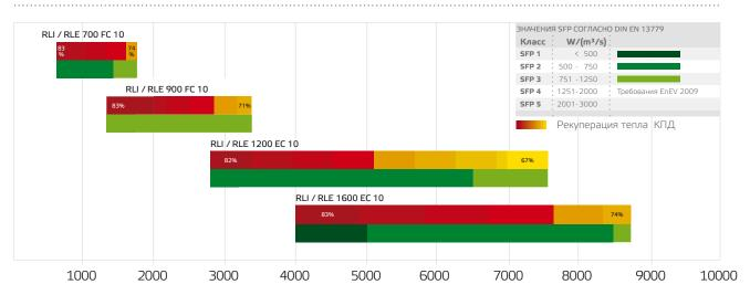
Значения SFP для каждого вентилятора при аэродинамическом сопротивлении воздуховодов 200 Па.
