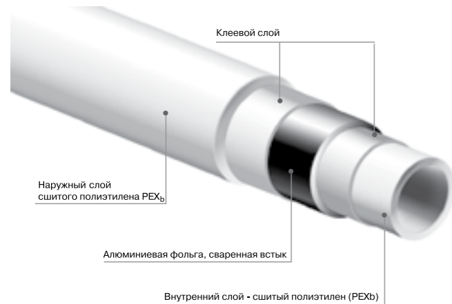
Рисунок 1. Структура трубы PE-Xb/Al/PE-Xb
