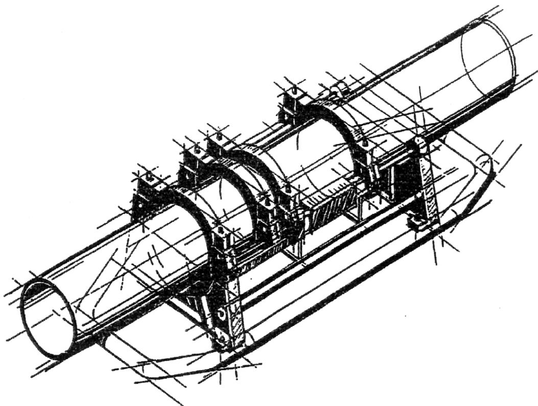
Машина для сварки встык нагревательным элементом
