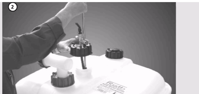
2 Арматуру для отбора-накопления с датчиком предельных значений и с плоским уплотнением Ø85/Ø68 мм x 3 мм установите на второй штуцер резервуара.
