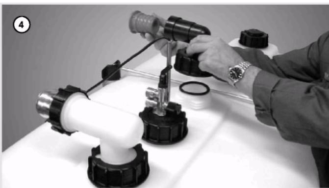
Закройте подсоединение к следующему резервуару с помощью концевой заглушки и гайки с прямой накаткой
