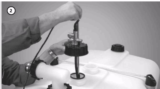
Установите угловую заливную трубу и соединение для заполнения (поз. 4 в таблице) на первый штуцер резервуара вместе со вставленной погружной трубой; смажьте уплотнительные кольца
