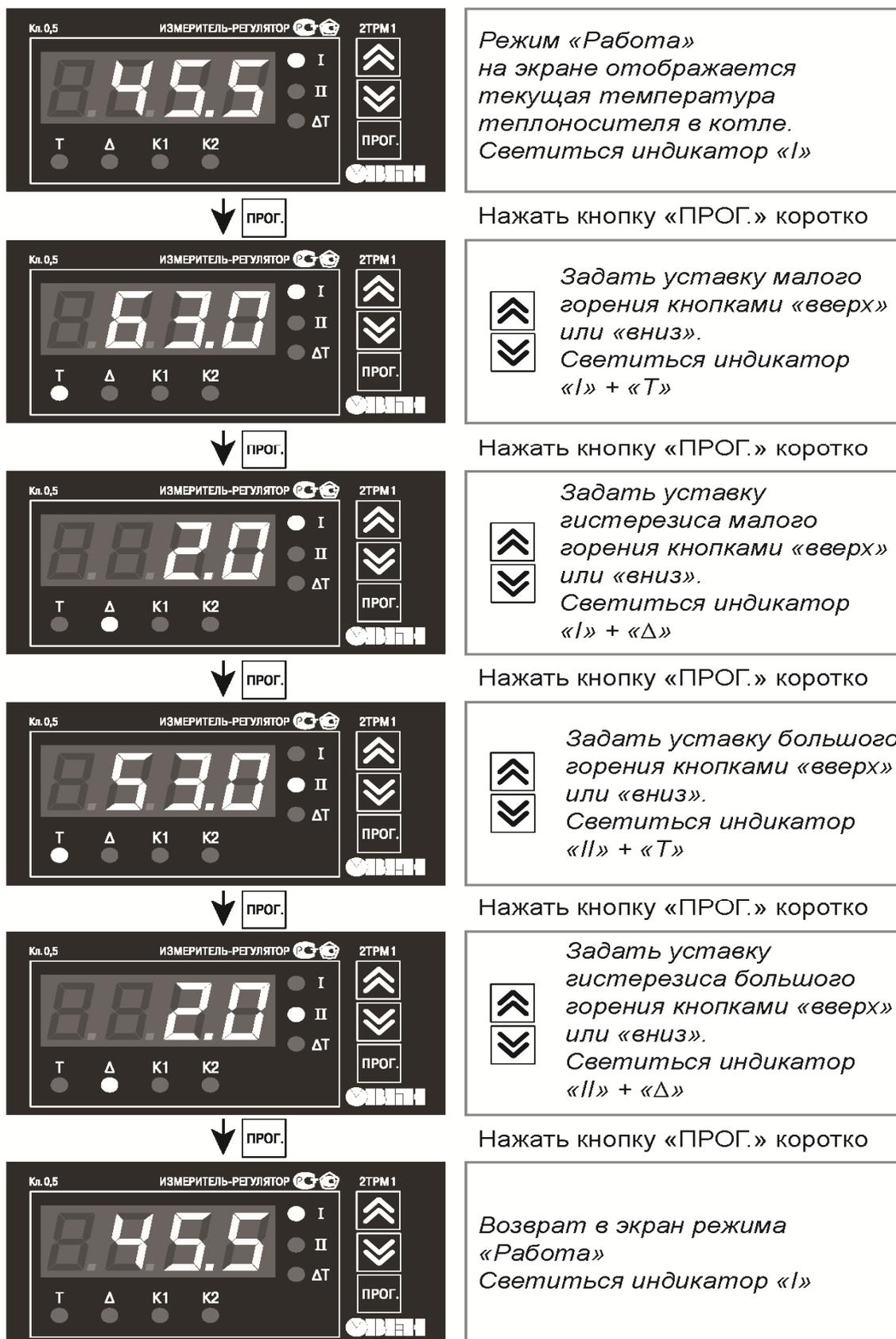
Рисунок 17. Изменение уставок малого и большого горения котла
