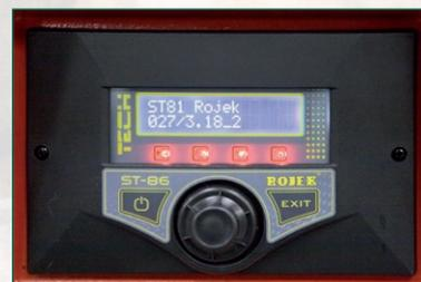
При применении данного типа регулятора с датчиком температуры продуктов сжигания сэкономим примерно 13% топлива, температура выходящей воды является очень стабильной, что оказывает влияние на более продолжительную долговечность теплообменника (котла). Контроль температуры продуктов сжигания на выходе из котла способствует более низким эмиссиям пыли и газов, вредных для окружающей среды. Тепловая энергия является полностью использованной для нагрева воды в котле и не исчезает в дымоходе.
