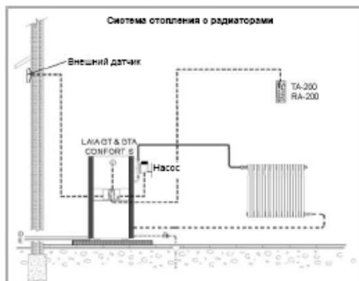
В следующей схеме рекомендуется использовать модуль зонирования MS-210, для быстрого и простого регулирования системы отопления.
