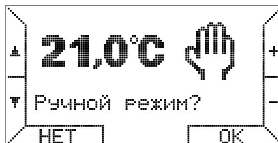
С помощью кнопок +/- можно варьировать температуру, а с помощью кнопки, соответствующей "ОК" активируется ручной режим.
