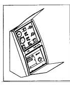
**RB/E – RB/E BOX** электронный пульт для управления работой котла и вспомогательного оборудования посредством электронного блока управления серии **RIELLO ESATTO**.
