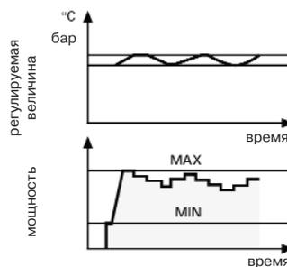
При плавном "модуляционном" регулировании горелка изменяет свою мощность в рамках диапазона модулирования, поддерживая контролируемый параметр (давление или температура) на заданном уровне. Необходимым элементом системы регулирования является датчик (давления или температуры) и электронный ПИД-регулятор (модулятор).
