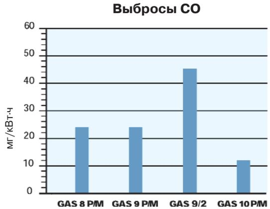
Данные по выбросам NO<sub>x</sub> и CO 1 класса (по Европейским нормам EN 676). Данные измерены при работе на максимальной мощности.
