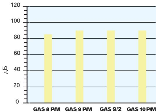
Уровень шума измерен на расстоянии 1 м от горелки при работе на максимальной мощности.
