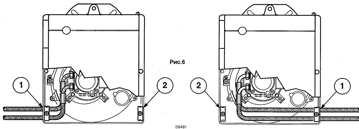
На обеих сторонах корпуса горелки предусмотрены гнезда для топливных шлангов. В зависимости от того, с какой стороны подводятся топливные шланги, ориентируются крепежная планка (1) и запорная накладка (2) (см. рис. 6).
