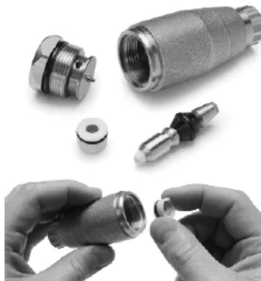
Рисунок 2 – Чистка насадки со снятием турбинного барабана
