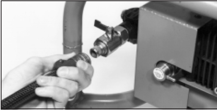
Рис.3 - Подсоедините к насосу шланг подачи воды. Закройте впускной кран (показан в закрытом положении)
