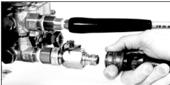
Рис.1 - Подсоедините к насосу шланг подачи воды. Закройте впускной кран (показан в закрытом положении)
