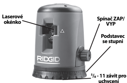
Obrázek 2 – Součásti laseru
