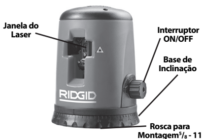
Figura 2 - Partes do Laser
