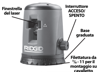
Figura 2 - Componenti della livella laser
