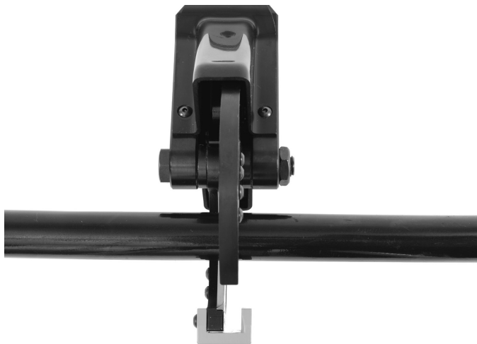
Figure 2 – Lames alignées sur le repère de coupe
