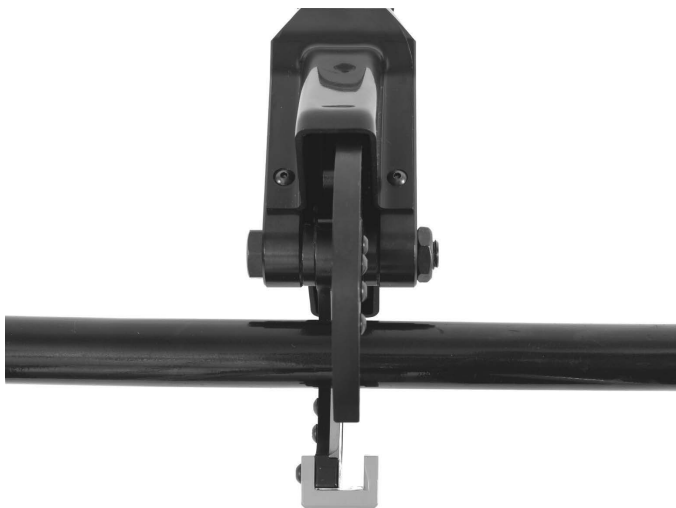
Şekil 2 – Tel іşareti ile Hizalanmış Kesici Kenar
