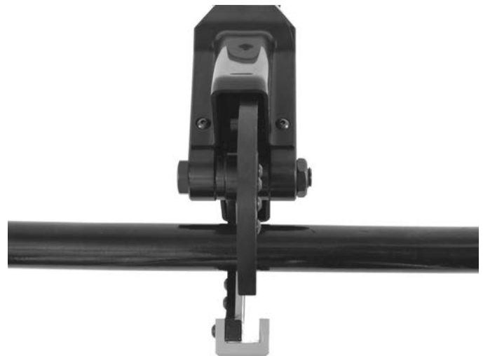
Afbeelding 2 – Snijrand uitgelijnd met merkteken op draad
