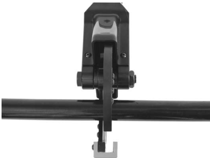
Figur 2 – Verktøget inriktat efter märket på kabeln
