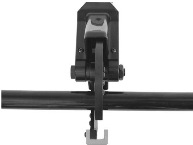
Figura 2 – Muchie de tăiere aliniată cu trasajul de pe sârmă
