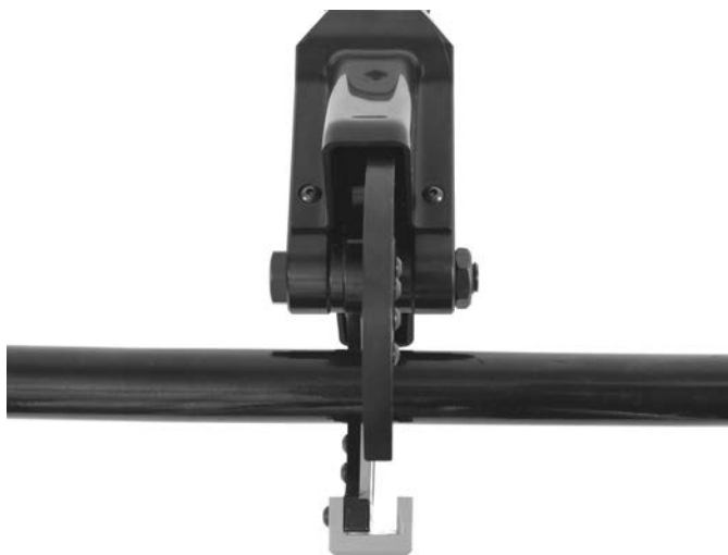
Obrázok 2 – Rezná hrana vyrovnaná so značkou na vodiči
