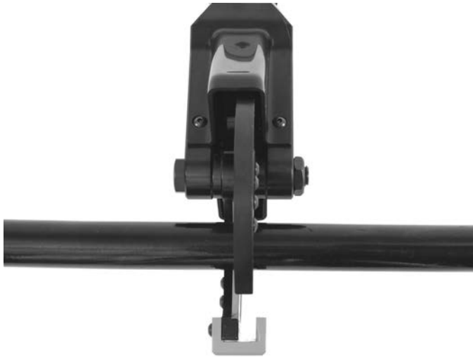
Εικόνα 2 – Ακμή κοπής ευθυγραμμισμένη με ένδειξη στο καλώδιο
