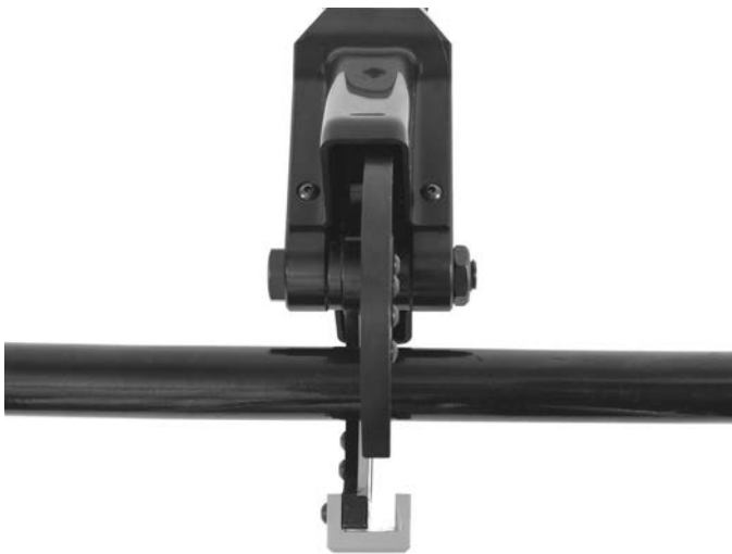
Abbildung 2 – Schneidkante an Markierung ausgerichtet
