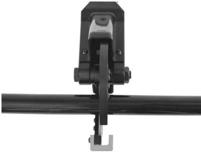
Obrázek 2 – Stříhací břity vyrovnané se značkou na kabelu
