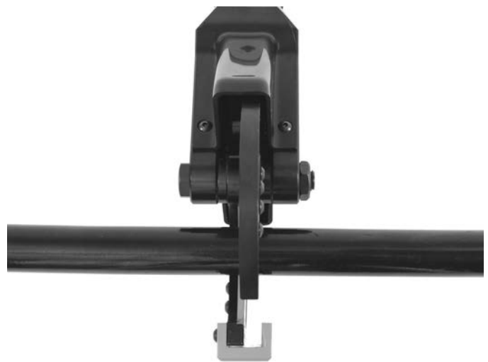
Figur 2 – Skær placeret i forhold til kabelmærke
