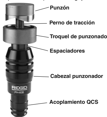
Figura 1 – Cabezal punzonador PH-60B
