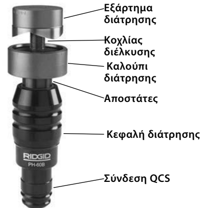
Εικόνα 1 – Κεφαλή διάτρησης PH-60B
