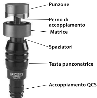
Figura 1 – Testa punzonatrice PH-60B
