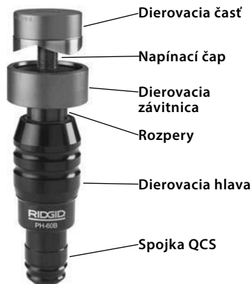
Obrázok 1 – Dierovacia hlava PH-60B
