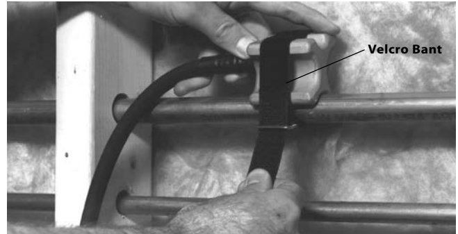
Şekil 5 – Dondurma Kafasının Velcro Bantla Uygulanması
