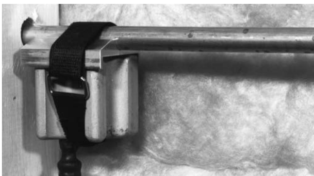
Slika 7 – Glava za zamrzavanje s krajnjim adapterom pričvršćenim Velcro trakom
