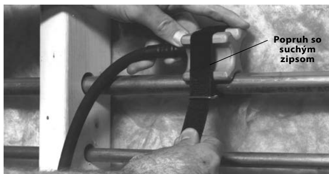
Obrázok 5 – Aplikácia zmrazovacej hlavy s popruhom so suchým zipsom
