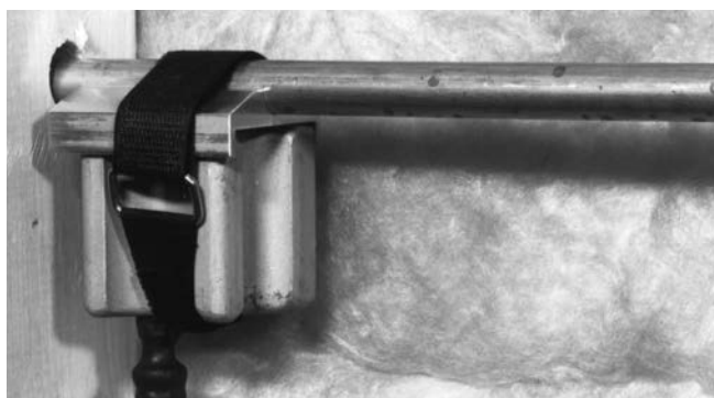
Figur 7 – Frysehoved med endeadapter fastgjort med velcrorem
