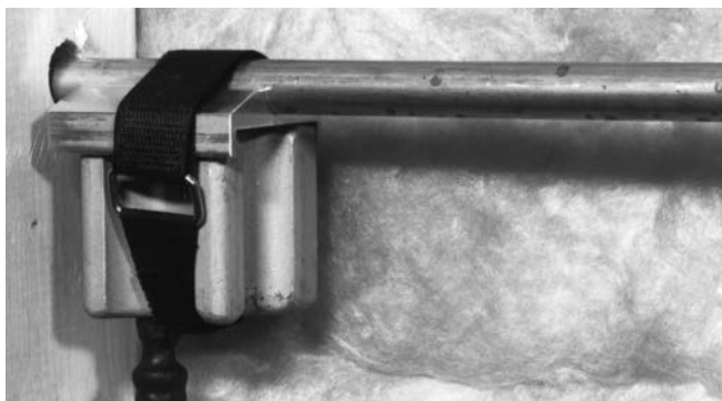
Figura 7 – Cabeça de congelação com adaptador de extremidade fixo com alça de velcro
