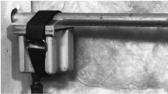
Abbildung 7 – Gefrierkopf mit Endadapter, mit Klettband befestigt
