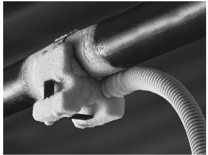
Εικόνα 9 – Ψυκτική κεφαλή με παγωμένο σωλήνα
