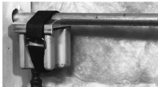
Figura 7 – Cap de înghețare cu adaptor de capăt atașat cu bandă Velcro
