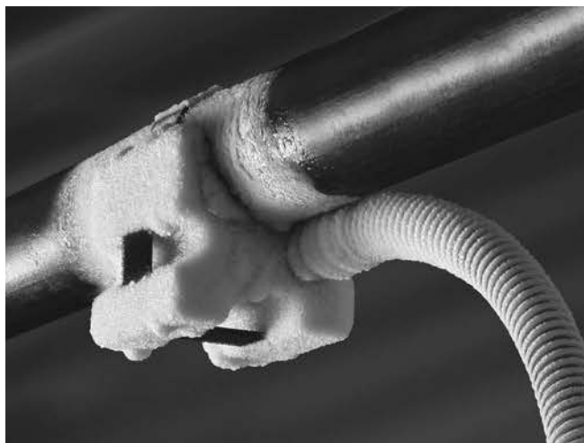
9. ábra – A fagyasztófej a csőhöz fagyott
