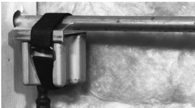
Obrázek 7 – Mrazicí hlava s koncovým adaptérem připojeným pomocí pásky se suchým zipem
