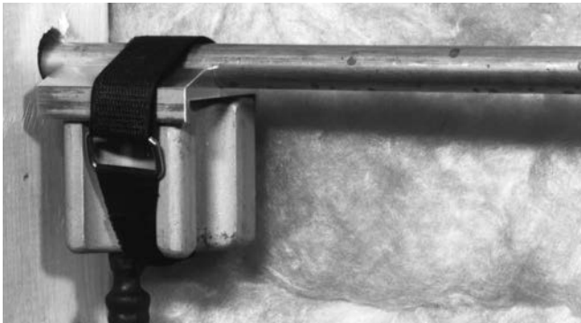
Kuva 7 – Tarranauhalla kiinnitetty pääteadapterilla varustettu jäädytyspää
