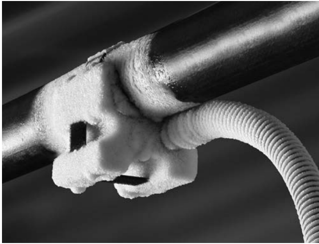
Figure 9 – Tête de congélation et tuyau gelés
