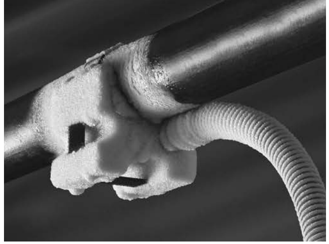
Şekil 9 – Borunun Üzerinde Donan Dondurma Kafası
