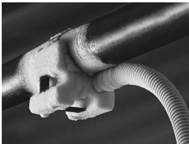
9-сурет – Мұздату басы құбырға қатырылған
