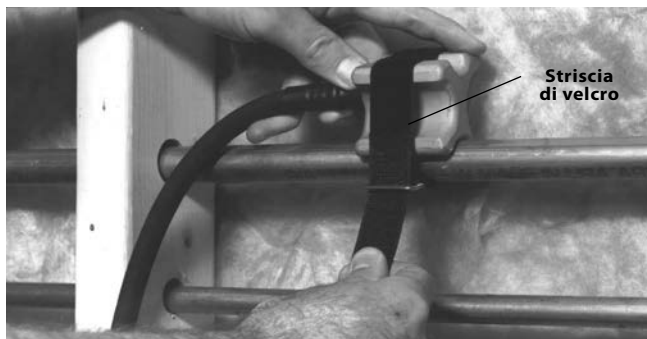
Figura 5 – Applicazione di una testa di congelamento con striscia di velcro
