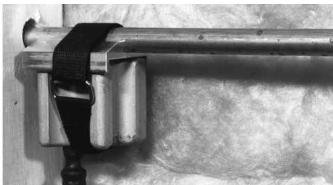
Rys. 7 – Głowica zamrażająca z adapterem końcowym zamocowanym paskiem na rzepey
