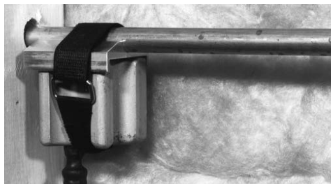
Slika 7 – Glava za zamrzavanje s krajnjim adapterom pričvršćenim čičak-trakom
