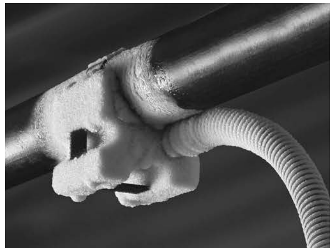
Рис. 9 – Примерзшая к трубе замораживающая головка
