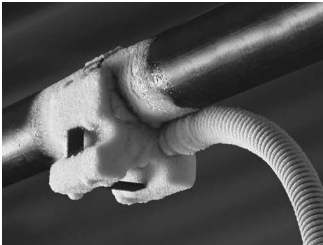
Figura 9 – Testa di congelamento congelata sul tubo
