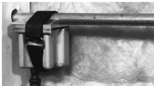
7. ábra – Fagyasztófej a különböző adapterekkel
