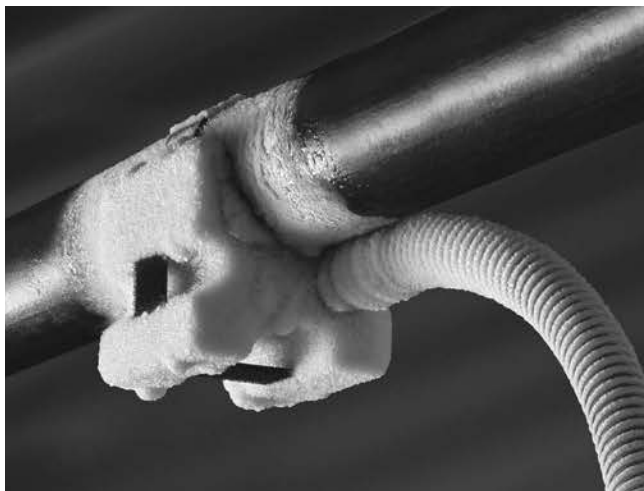
Obrázek 9 – Mrazicí hlava přimrzlá k trubce
