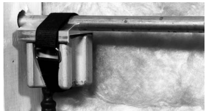
Figure 7 – Tête de congélation équipée d'un adaptateur d'embout et maintenue par une bande Velcro
