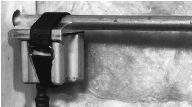
Figuur 7 – Vriesskop met eindadapter bevestigd met klittenband
