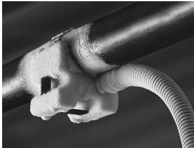
Slika 9 – Glava za zamrzavanje zamrznuta za cijev
