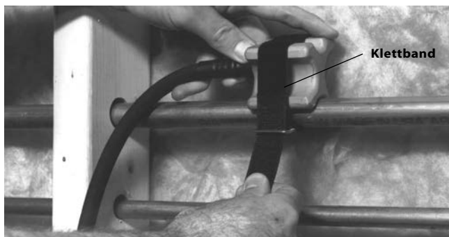
Abbildung 5 – Anbringen des Gefrierkopfs mit Klettband
