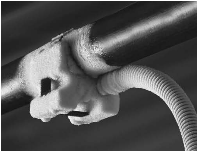
Abbildung 9 – Gefrierkopf an Rohr gefroren
