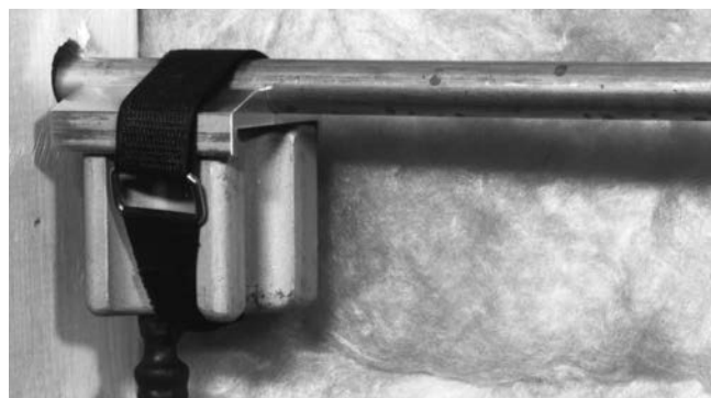
7-сурет – Velcro қайысы арқылы тіркелген соңғы адаптері бар мұздату басы
