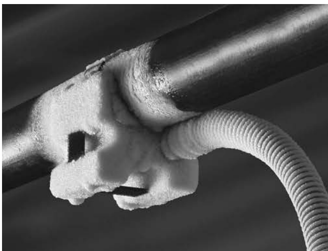
Slika 9 – Zaleđena glava za zamrzavanje na cevi
