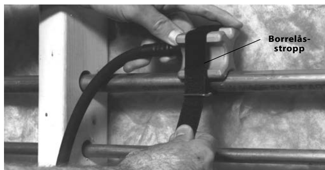
Figur 5 – Bruke frysehode med borrelås-stropp
