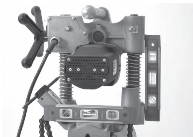
Figura 10 – Nivelamento da HC-300
