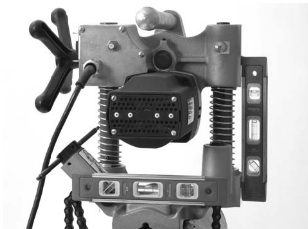
Figure 10 – Mise de niveau de la HC-300
