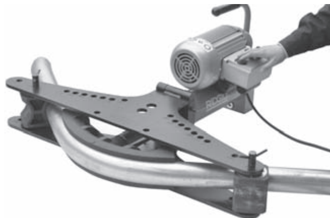
Abbildung 14 – Benutzung des elektrischen Rohrbiegers
