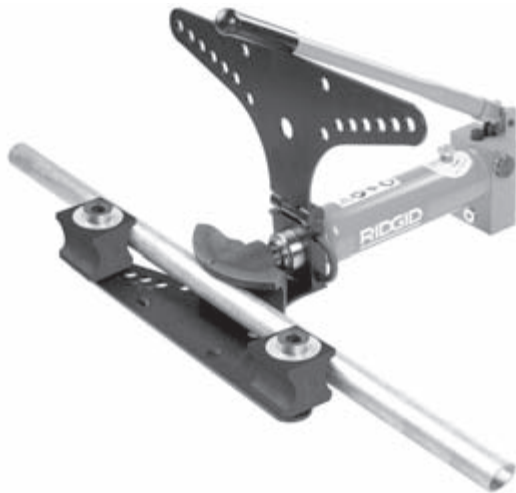
Abbildung 9 – Einlegen des Rohrs
