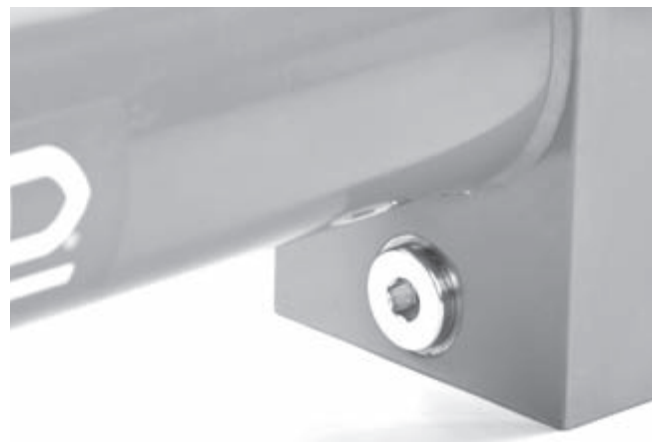
Abbildung 19 – Hydrauliköl-Ablasstopfen und Zugang zum Filter
