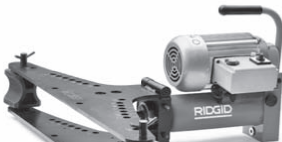
2. ábra – Hidraulikus csőhajlító gép, 2"-es és 3"-es, villamos működtetésű egység
