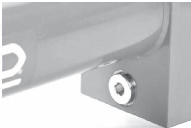
Rysunek 19 – Korek spustowy oleju hydraulicznego i dostęp do filtra
