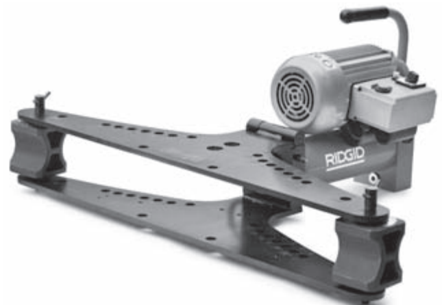
Figura 7 – Dispozitivul de curbat electric de 2"/3" asamblat
