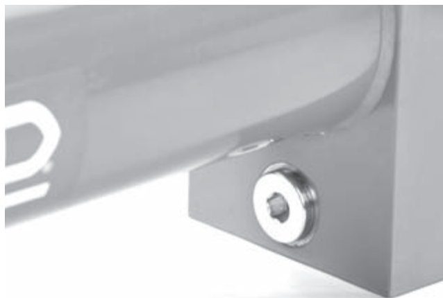
Figura 19 – Tappo di scarico dell'olio idraulico e Accesso al Filtro
