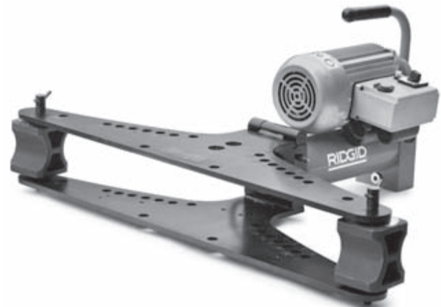
Figuur 7 – Assembleren van elektrische 2"/3"-pijpbuiger
