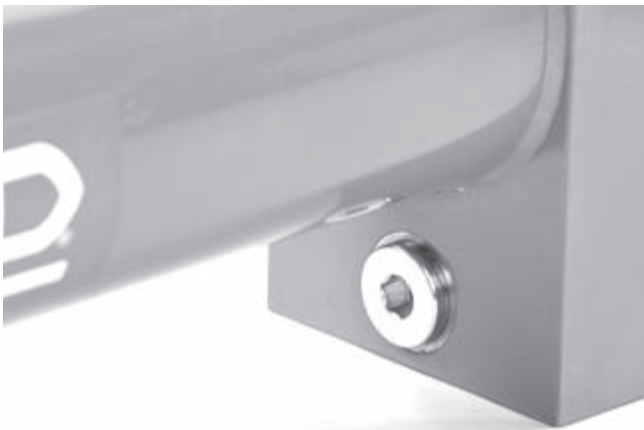
Figur 19 – Hydrauloljans tömningsplugg och åtkomst till filtret
