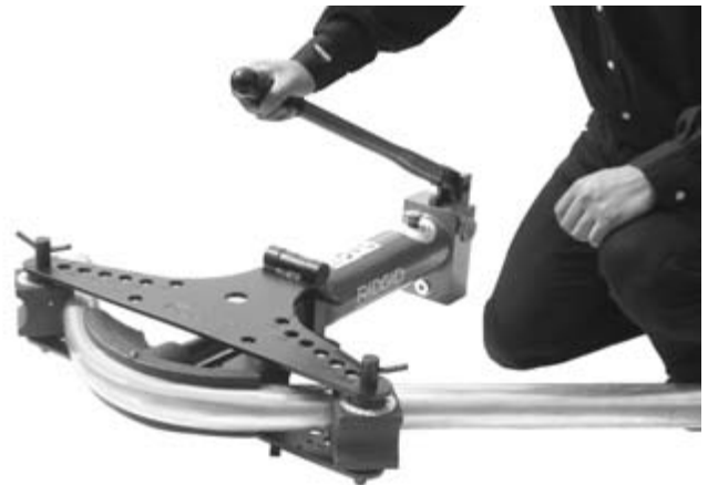
Figure 13 – Utilisation d'une cintreuse manuelle
