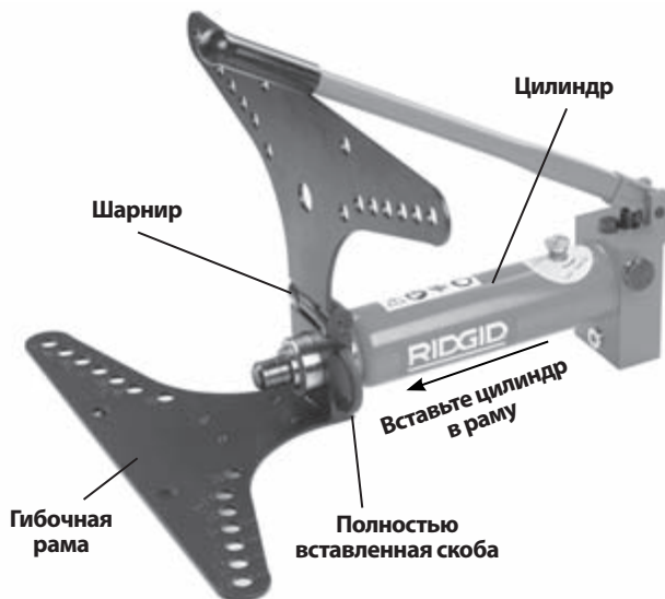
Рис.5 – Сборка 2" и 3" гибочных машин
