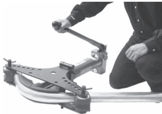
Abbildung 13 – Benutzung des manuellen Rohrbiegers
