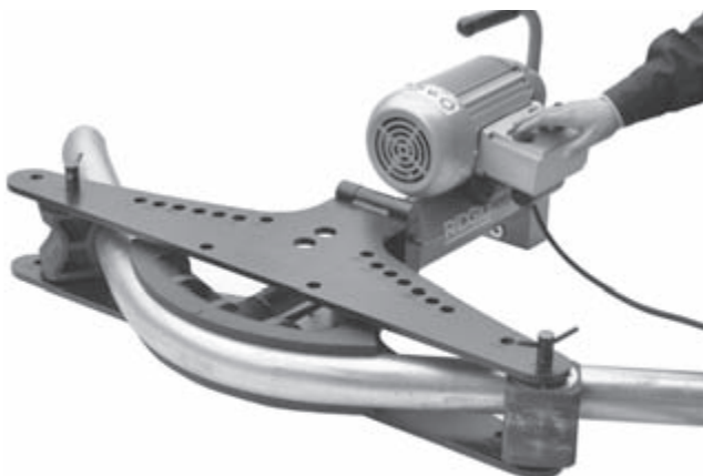
Рис.14 - Работа на электрической гибочной машине
