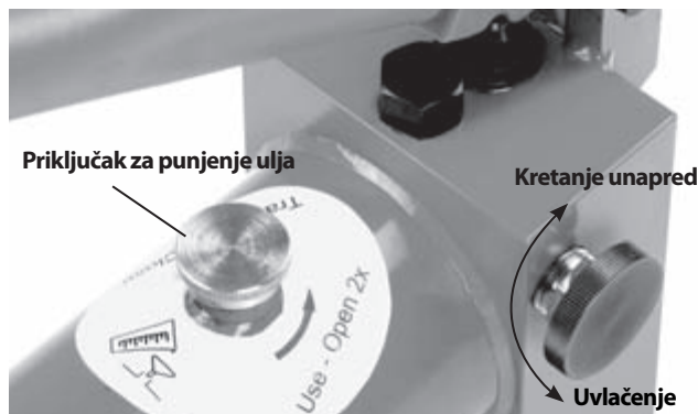
Slika 10 – Položaji dugmeta za oslobađanje (napred/nazad)
