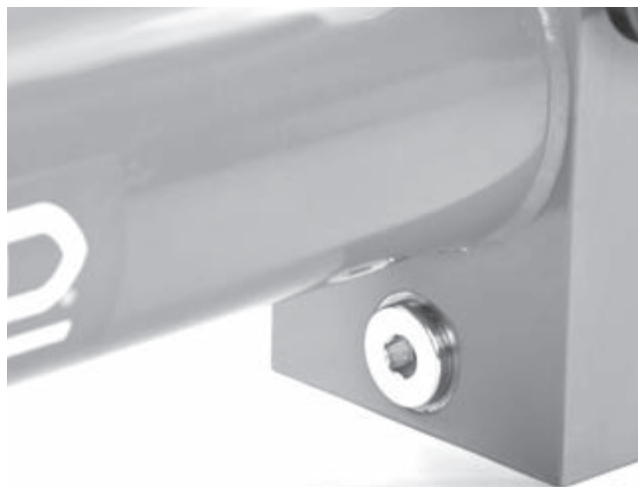
Obrázok č. 19 – vypúšťacia zátka hydraulického oleja a prístup k filteru
