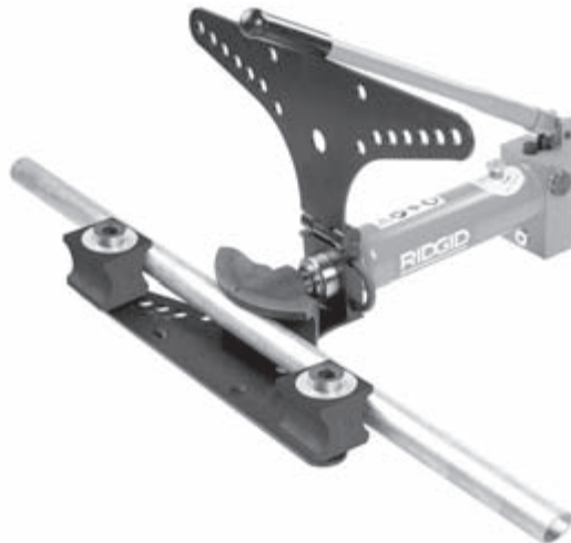
Figuur 9 – De pijp aanbrengen in de machine
