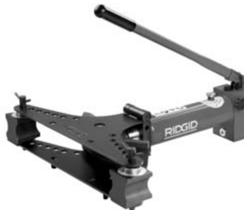
Figure 6 – Cintreuse manuelle Ø 2" et 3" assemblée
