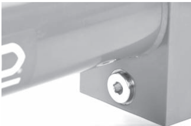
Slika 19 – Čep za ispuštanje hidrauličnog ulja i pristup do filtera
