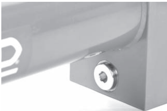
Slika 19 – Čep za pražnjenje hidrauličnog ulja i pristup filtru
