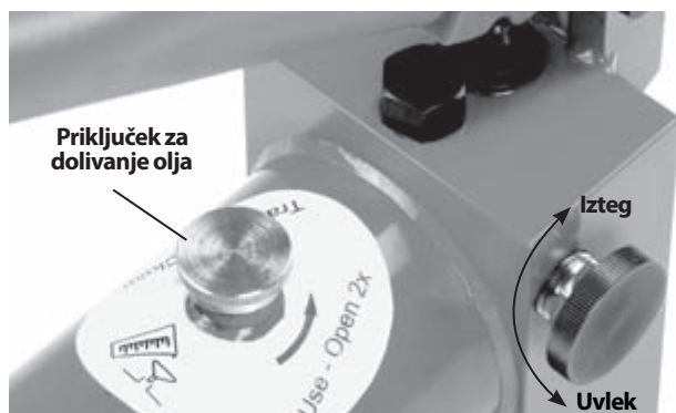
Slika 10 – Položaja gumba za sprostitve (izteg/uvlek)
