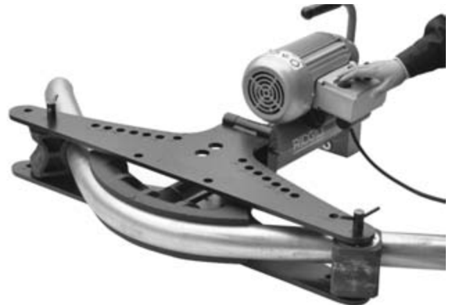
Figure 14 – Utilisation d'une cintreuse électrique
