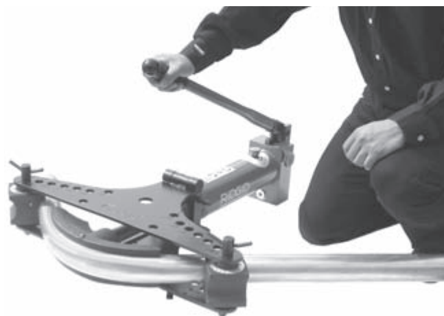
Figura 13 – Trabalhar com o Curvador Manual
