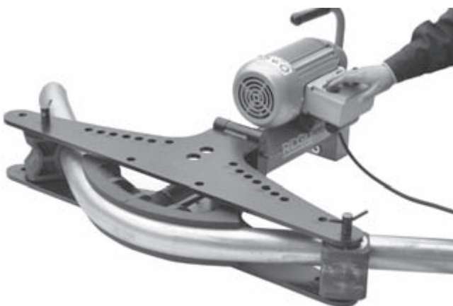
Figur 14 – Betjening af den elektriske bukkemaskine
