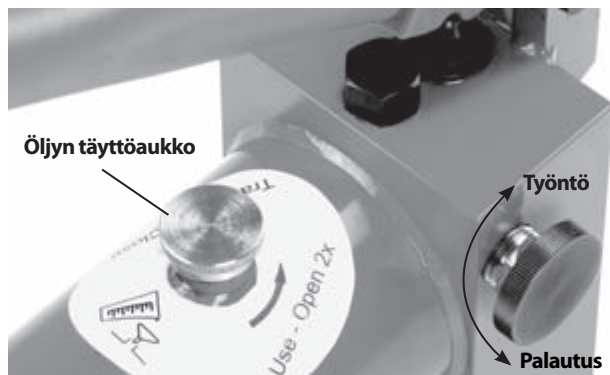
Kuva 10: Vapauttimen asennot (työntö/palautus)
