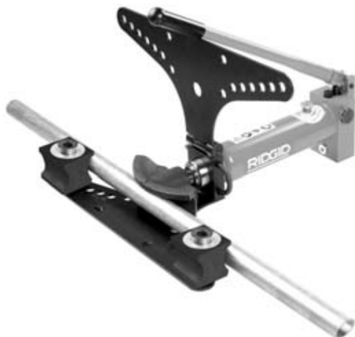
Figure 9 – Positionnement du tuyau
