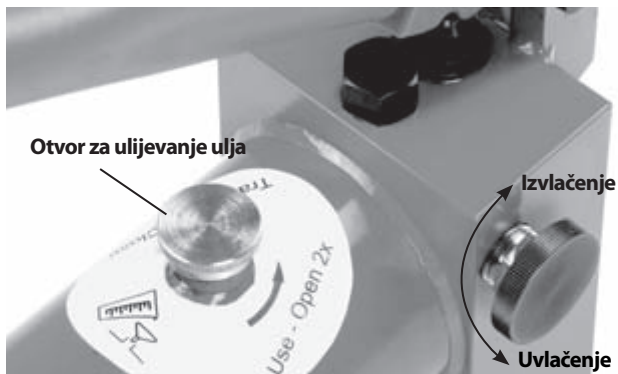
Slika 10 – Položaji otpusnog gumba (izvlačenje/uvlačenje)
