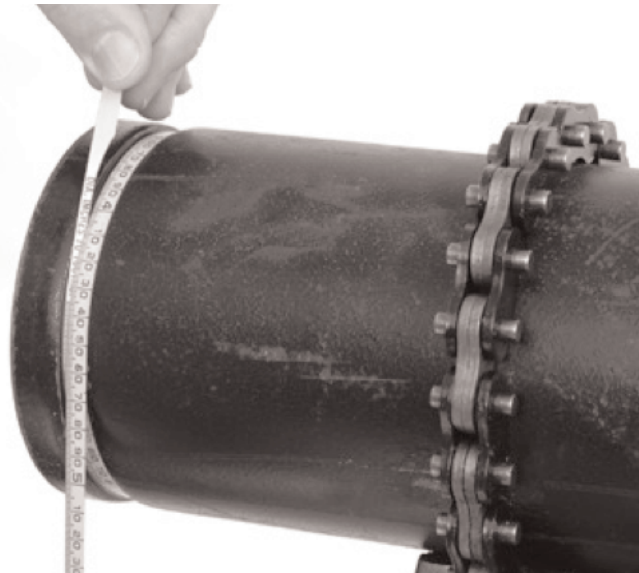
Рисунок 11 – Проверка диаметра желобка с помощью измерительной ленты
