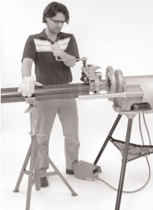
Рисунок 13 – Нажим на трубу с целью улучшения прокатки
