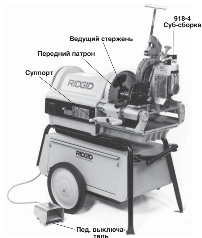
Рисунок 6 – Желобонакатчик № 918-4 на резьбонарезном станке № 1224
