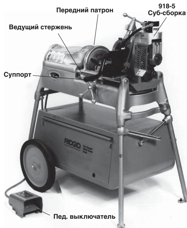
Рисунок 8 – Желобонакатчик № 918-5 на резьбонарезном станке № 535
