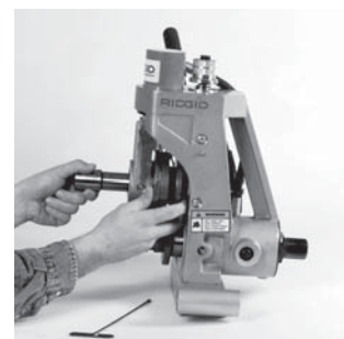
Рисунок 18 – Снятие удерживающего вала и накаточного ролика
