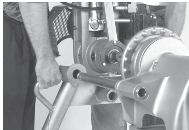
Рисунок 4 – Надевание желобонакатчика на опорные рычаги
