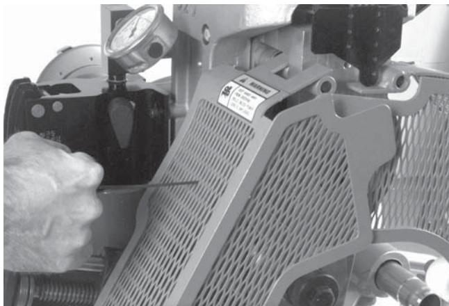
Рисунок 18 – Ослабление установочного винта в кожухе верхнего ролика
