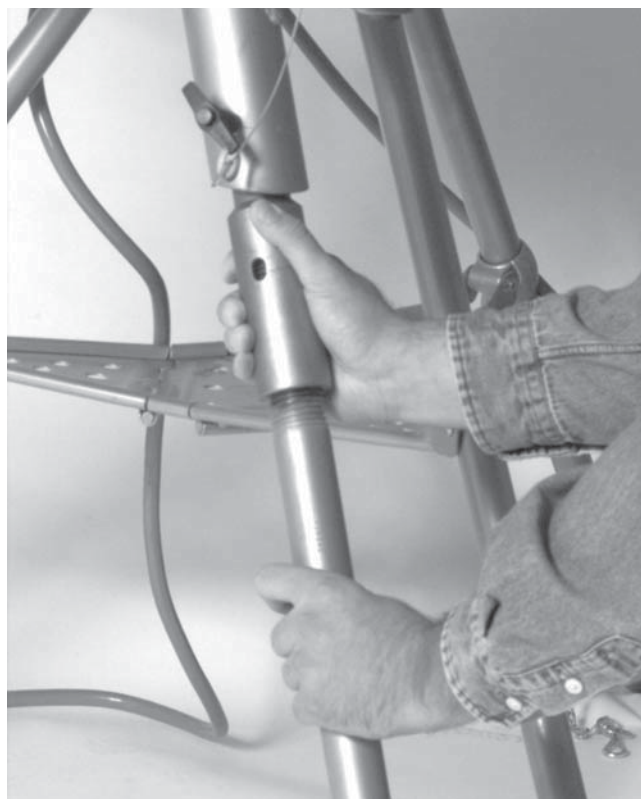
Рисунок 6 – Регулировка ножек для выравнивания желобонакатчика
