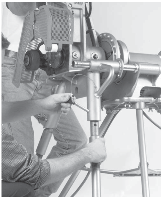
Рисунок 23 – Снятие ножек с основания
