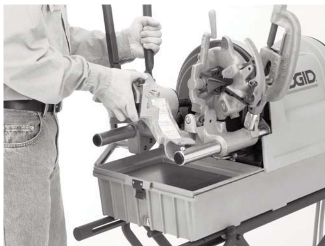
Рисунок 4 – Монтаж на резьбонарезной станок 1822-I (то же для станков 300 Compact и 535)
