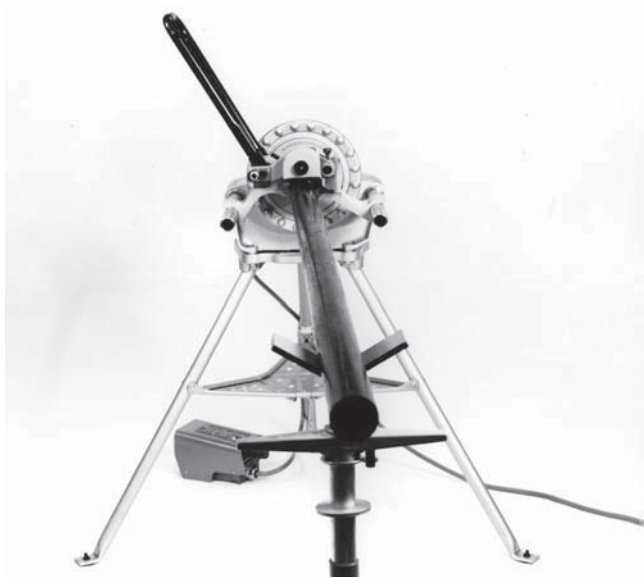
Рисунок 8Б – Использование станка в режиме FORWARD (FOR)
