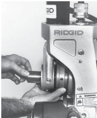
Рисунок 12 – Снятие вала накаточного ролика и самого ролика
