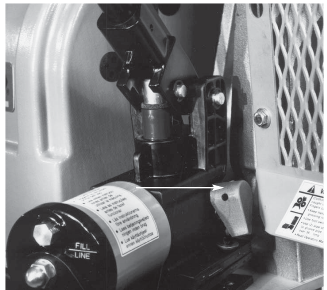
Рисунок 4 – Крупный план расцепляющего рычага на насосе 918-I
