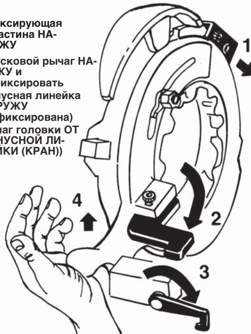
Рисунок 12 – Настройка самооткрывающихся головок № 714 или 914 на резьбы NPSM или BSPP
