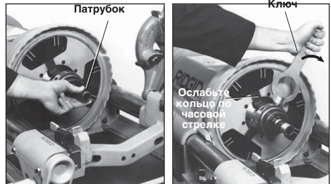
Рисунок 30 – Установка необработанного патрубка и освобождение готового патрубка с помощью ключа
