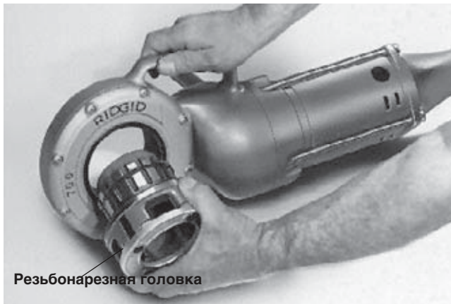
Рисунок 3 – Установка головки № 12-R с откидным верхом
