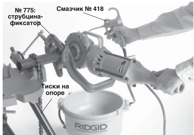
Рисунок 4 – Нарезание резьбы на трубу 2" с помощью привода, расположенного слева от тисков
