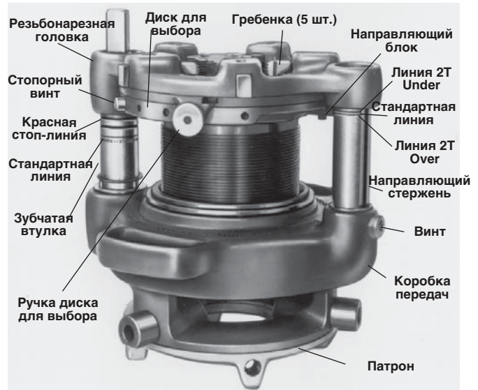
Рисунок 8 – Головка № 141 с зубчатой передачей с опорными линиями зубчатой втулки и направляющего стержня (то же в случае с головкой № 161)
