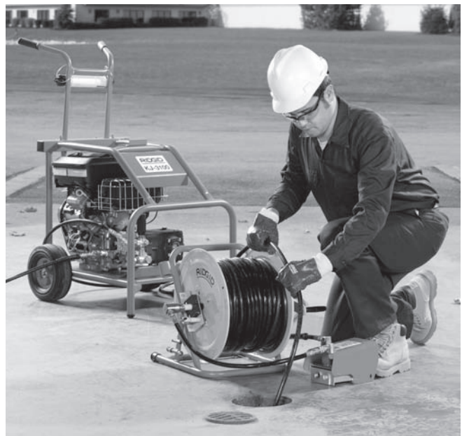
Figura 14 - Poziția corectă de exploatare
