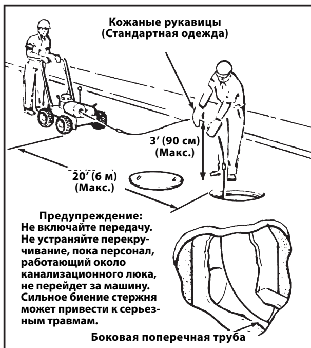
Рис. 3 – Использование стержневой прочистной машины
