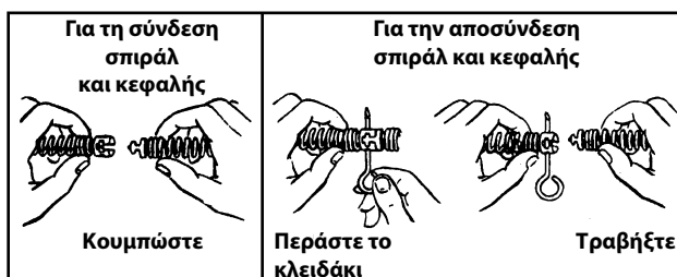
Εικόνα 1: Σύνδεση και αποσύνδεση σπιδάλ και κεφαλών
