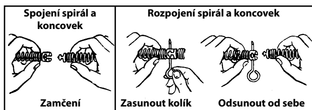
Obrázek 1: Spojování a odpojování spirál a koncovek
