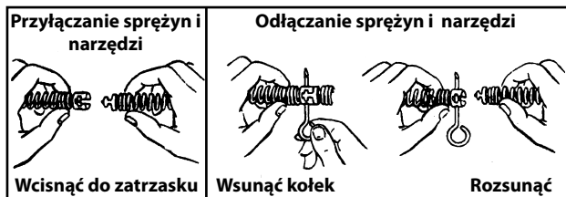
Rysunek 1: Przyłączanie i rozłączanie sprężyn i narzędzi
