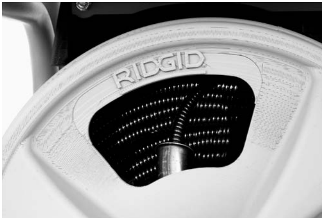
Figura 17 – Enrolle el cable en el tambor tal como se muestra
