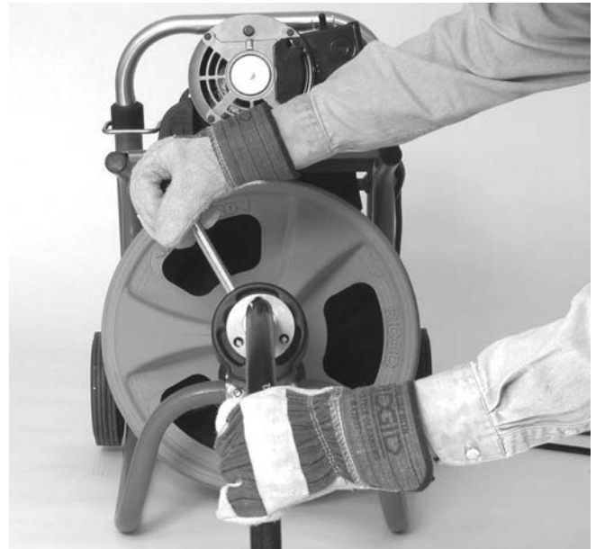
Figur 15 – Använda maskinen med styrslang
