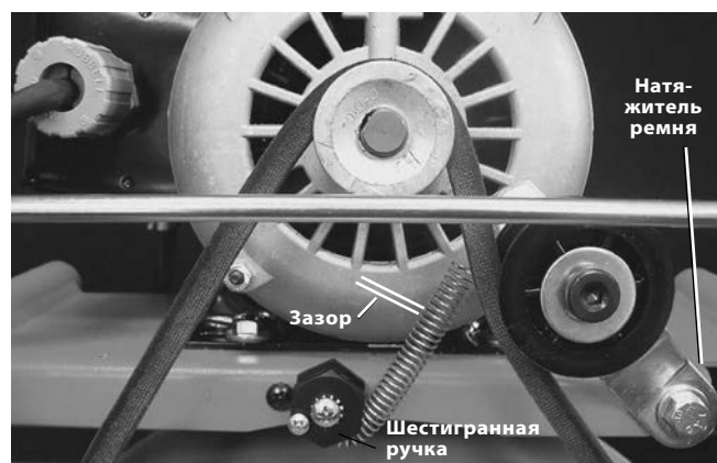
Рисунок 16 – Регулировка ограничителя крутящего момента. (Показано со снятым кожухом ремня)
