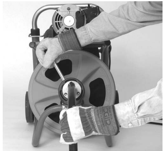
Figur 15 – Bruke maskinen med ledeslange
