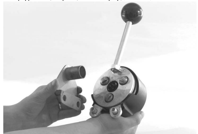
Εικόνα 3 – Τοποθέτηση βάσης στήριξης στο AUTOFEED (Μηχανισμός αυτοπροώθησης)
