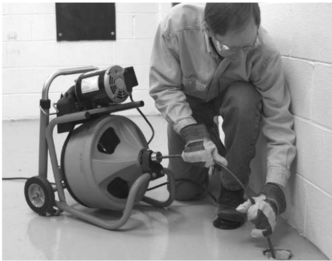
Figur 12 – I driftsposisjon, manuell mateledning
