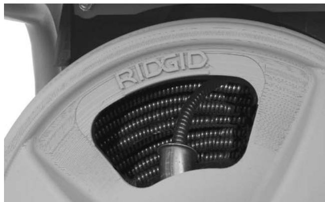
Figur 17 – Sno spiralen ind i tromlen som vist
