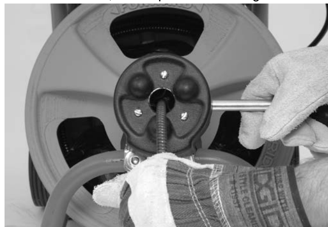
Figura 14 – AUTOFEED en posición para retraer el cable
