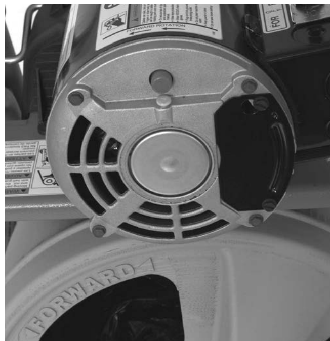
Figura 8 – Frecce della direzione di rotazione del tamburo
