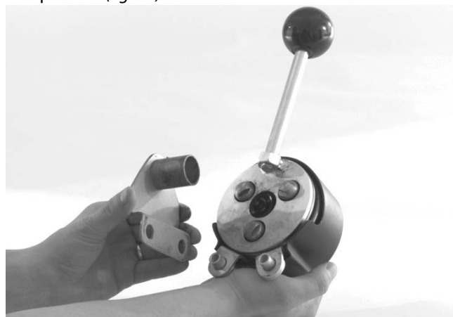
Figur 3 – Plassere festebrakett i AUTOFEED
