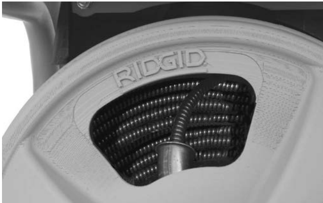
Abbildung 17 – Spirale in die Trommel schieben, wie gezeigt
