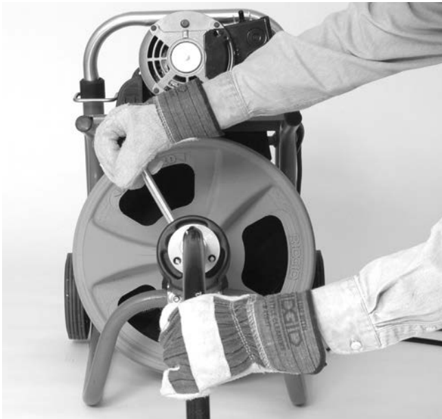
Figure 15 – Utilisation de l'appareil avec tuyau de guidage
