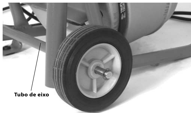
Figura 2 – Montagem da roda
