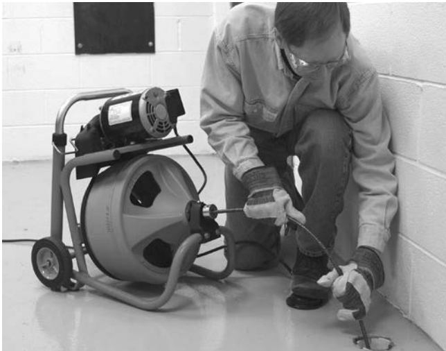
Figuur 12 – In bedieningspositie, handmatige veervoer
