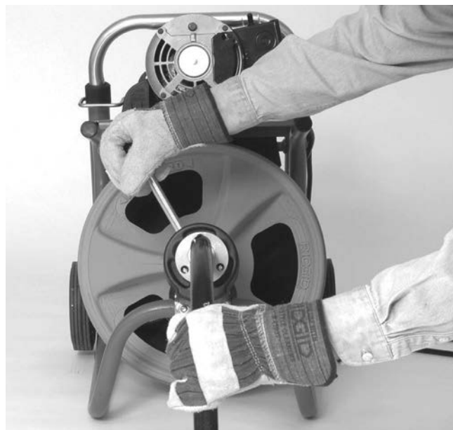
Figur 15 – Anvendelse af maskinen med styreslange
