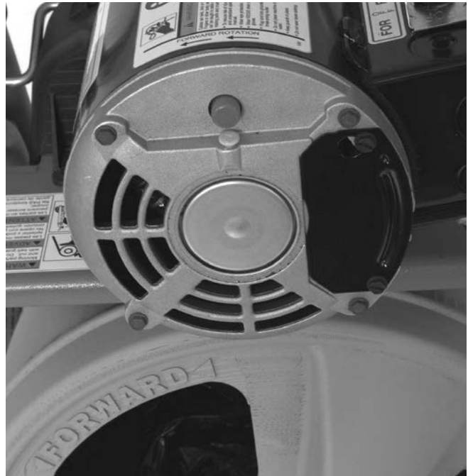
Εικόνα 8 – Βέλη κατεύθυνσης περιστροφής τυμπάνου
