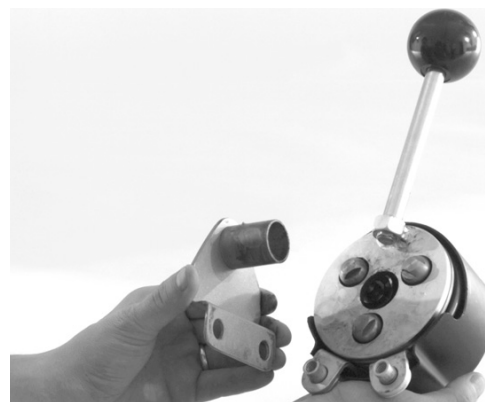
Figura 3 – Modo de colocar la pieza de montaje en el auto-alimentador
