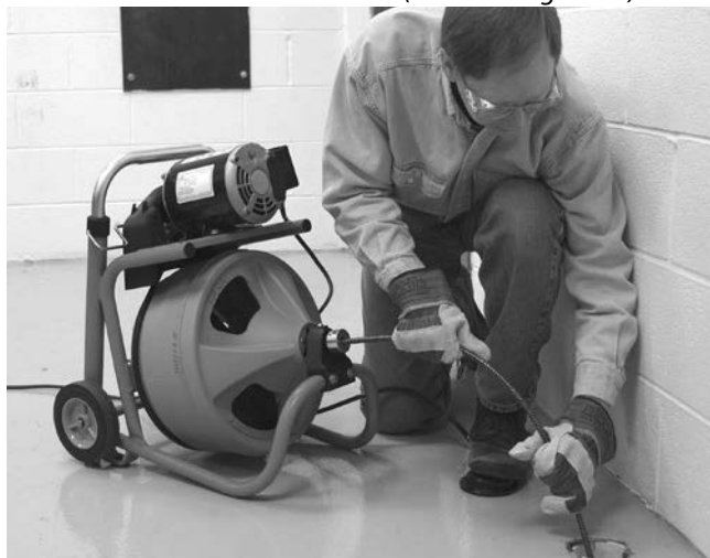
Figura 12 – In posizione operativa, inserimento manuale del cavo
