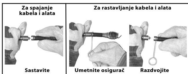
Slika 11 – Spajanje i odvajanje alata
