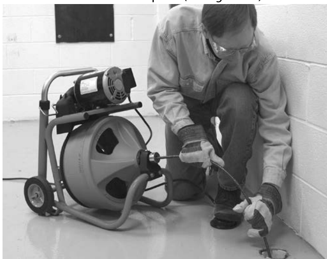
Figura 12 – Na posição de operação, cabo de avanço manual
