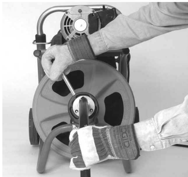
Slika 15 – Korišćenje mašine sa crevom za navođenje
