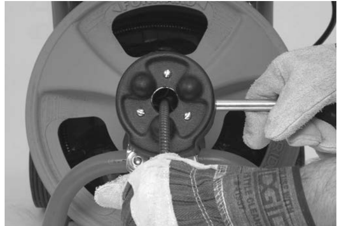
Figuur 14 – AUTOFEED in terugtrekstand
