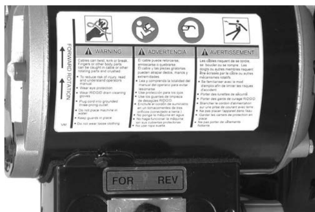
Figura 7 – Etichetta di avvertimento - Motore
