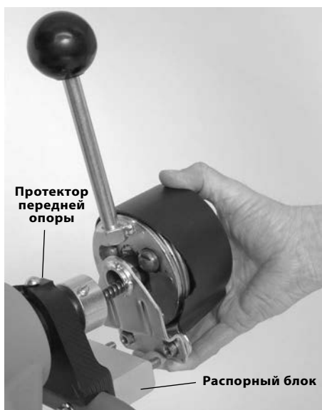
Рисунок 4 – Монтаж AUTOFEED на раме
