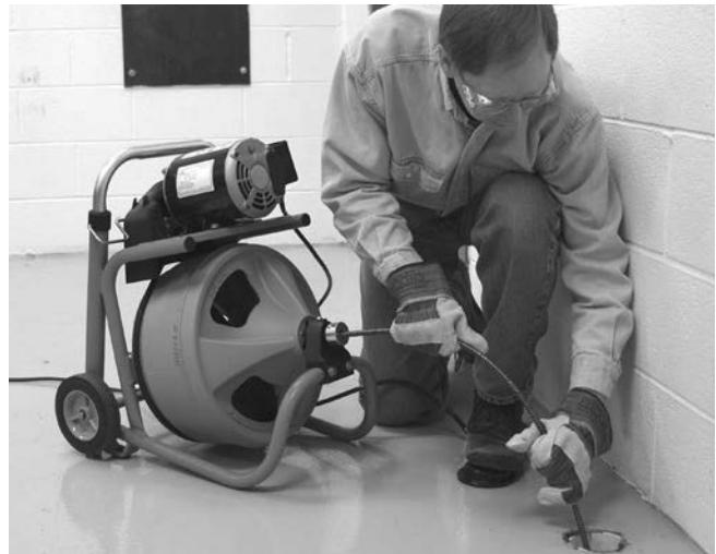
12-сурет – Жұмыс күйінде, кабельді қолмен беру
