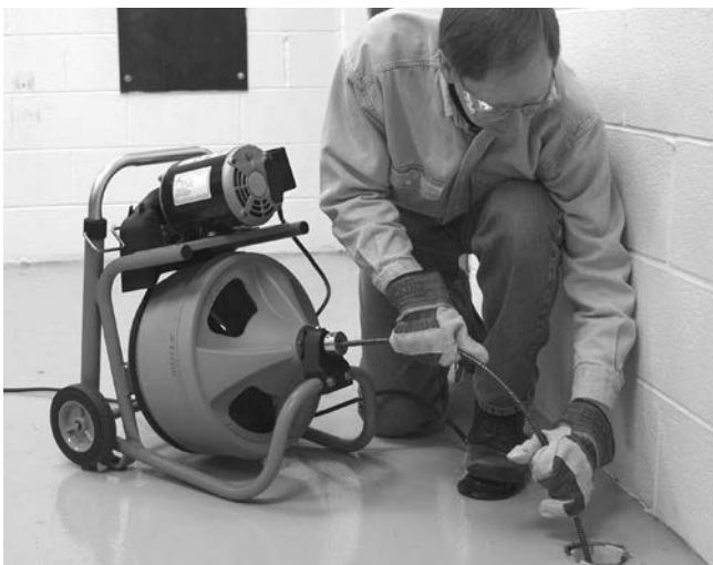
Abbildung 12 – In Betriebsposition, manueller Vorschub der Spirale
