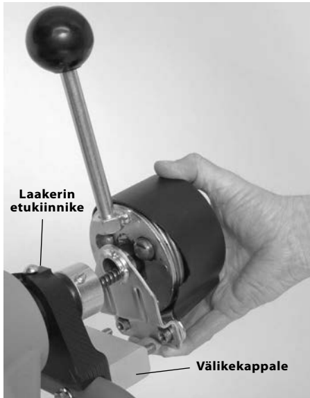
Kuva 4 – AUTOFEED-automaattisyötön kiinnitys runkoon
