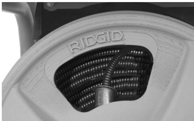
Figuur 17 - Wikkel de veer in de trommel op zoals afgebeeld
