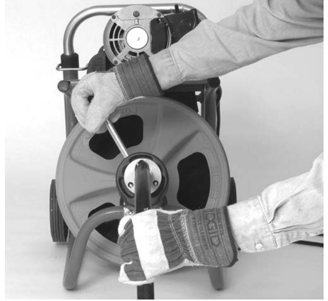
Şekil 15 – Makinenin Kılavuz Hortumla Kullanılması
