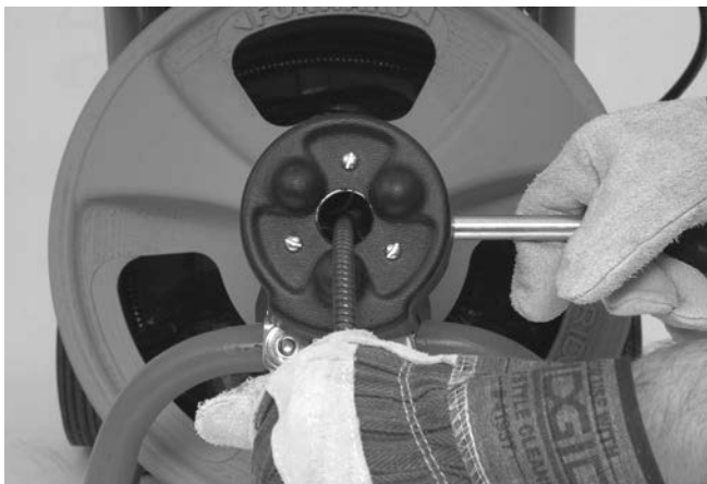
Slika 14 – AUTOFEED u položaju povlačenja
