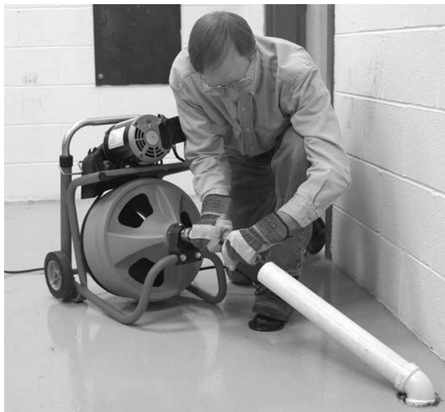
9. ábra – Példa lefolyótoldatra a dobtól számított 2'-ig
