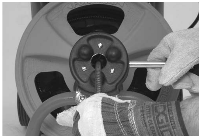
Εικόνα 14 – AUTOFEED (Μηχανισμός αυτοπροώθησης) στη θέση απόσυρσης
