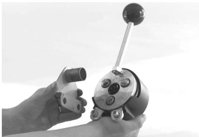
Obrázek 3 – Umístění montážní konzoly do AUTOFEED
