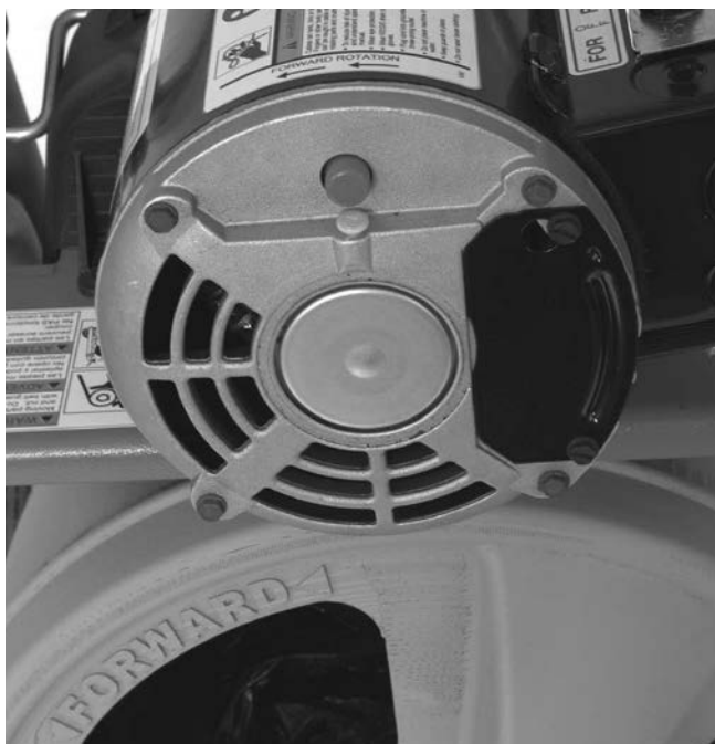
Figur 8 – Pile, der angiver tromlens rotationsretning
