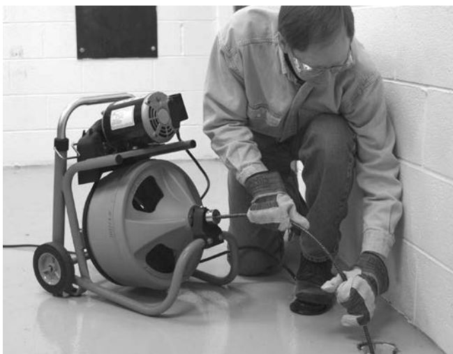
Figur 12 – Ibetjeningsstilling, manuel indføring af spiral
