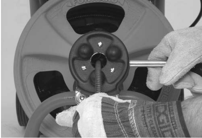
Figura 14 – AUTOFEED in posizione di recupero
