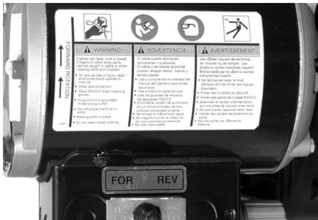
Figura 7 – Etiqueta de advertencias sobre el motor
