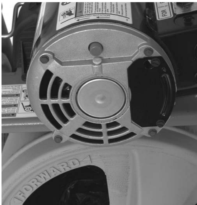
Obrázek 8 – Šipky směru otáčení bubnu
