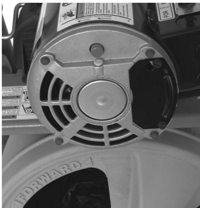
Rys. 8 – Strzałki kierunku obrotu bębna
