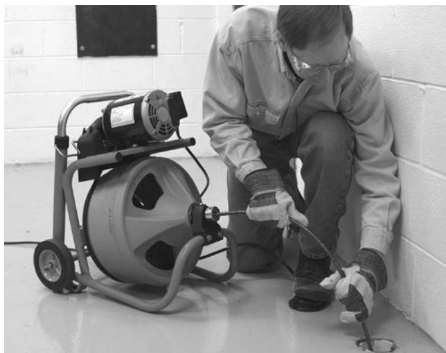
Obrázok 12 – Vprevádzkovej polohe, manuálny posuv špirály
