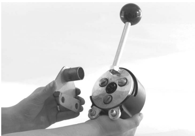
Slika 3 – Postavljanje obujmice nosača u AUTOFEED
