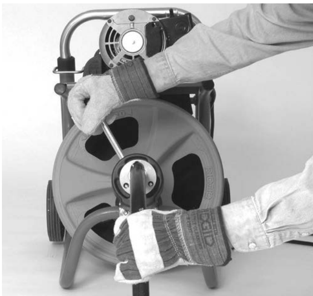
Figura 15 – Utilizar máquina com mangueira guia
