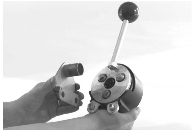
Abbildung 3 – Einsetzen der Befestigungshalterung in die AUTOFEED
