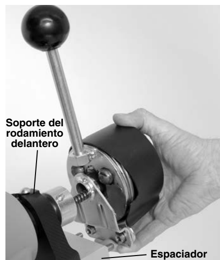
Figura 4 – Montaje del AUTOFEED a la armazón
