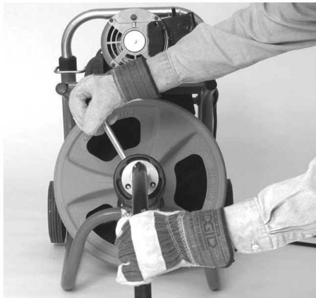
Figura 15 – Utilizzo della stasatrice con il tubo guida
