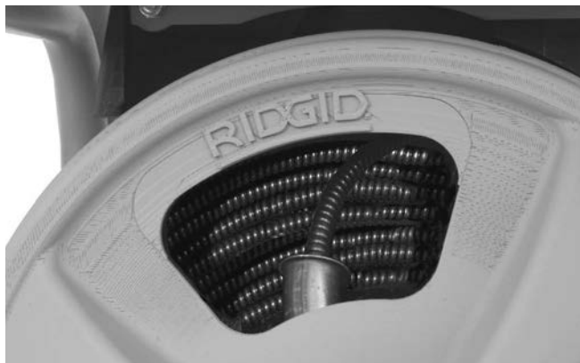
Slika 17 – Namotajte sajlu u bubanj kako je prikazano
