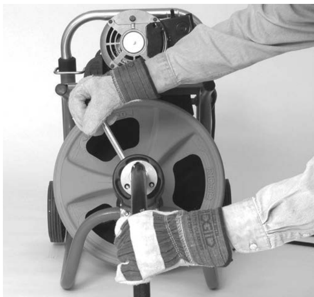
Slika 15 – Korištenje uređaja s vodilicom crijeva
