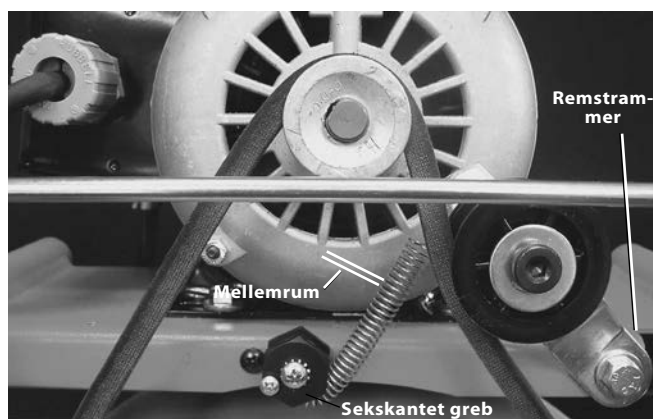
Figur 16 – Justering af torsionsbegrænser. (Vist med remafskærmningen afmonteret)
