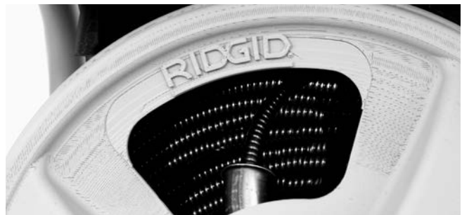
Figure 17 – Enrouler le câbler dans le tambour comme indiqué
