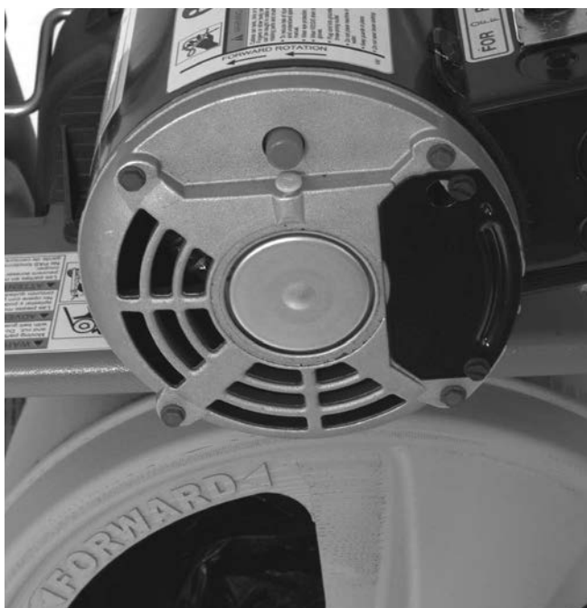
Figura 8 – Săgeți de sens de rotație tambur
