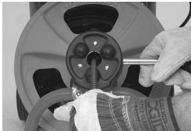
Rys. 14 – Mechanizm AUTOFEED w położeniu wciągania
