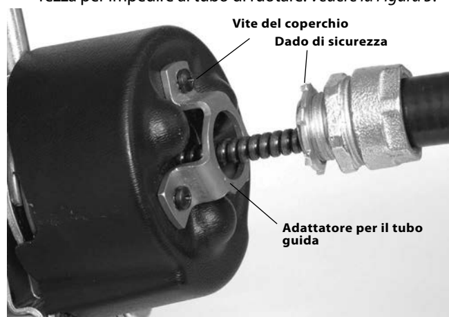
Figura 5 – Montaggio del tubo guida all'AUTOFEED
