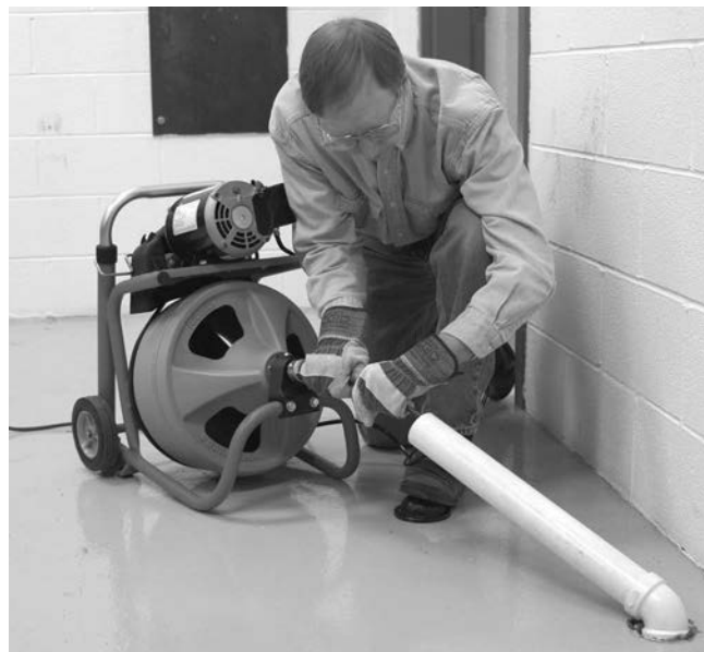
Figura 9 – Exemplu de prelungire a canalului la mai puțin de 2" de deschiderea canalului
