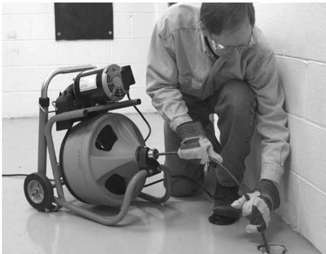
Slika 12 – U poziciji za rad, ručno uvlačenje sajle
