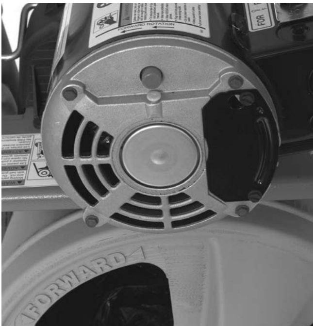
Figur 8 – Riktningspilar för trummans rotation
