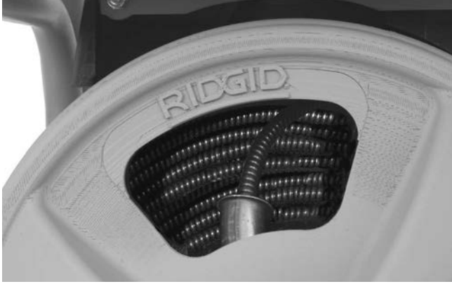
Şekil 17 – Spirali Makaraya Gösterildiği Gibi Sarın
