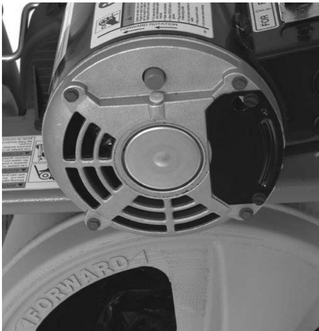
Abbildung 8 – Pfeile für Trommelrotationsrichtung
