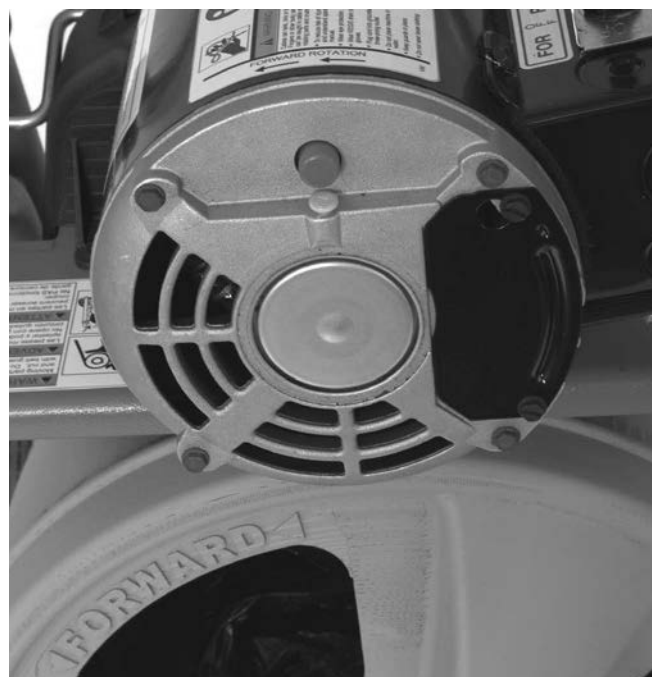
8. ábra – A dob forgásirányát jelző nyilak
