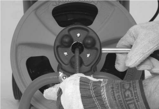
Şekil 14 – OTOMATİK BESLEME Geri Alma Konumunda
