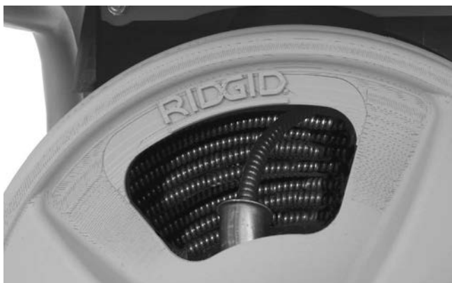
Рисунок 17 – Смотайте спираль в барабан, как показано
