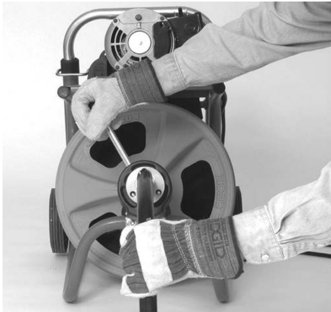
Obrázok 15 – Používanie stroja s vodiacou hadicou
