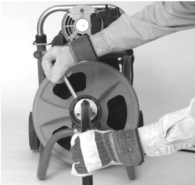
Abbildung 15 – Verwendung der Maschine mit Führungsschlauch
