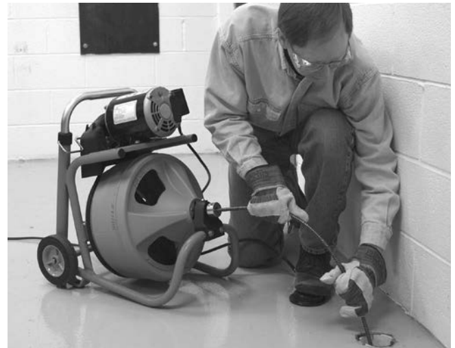
Kuva 12 – Käyttöasennossa, avausjousen syöttö käsin
