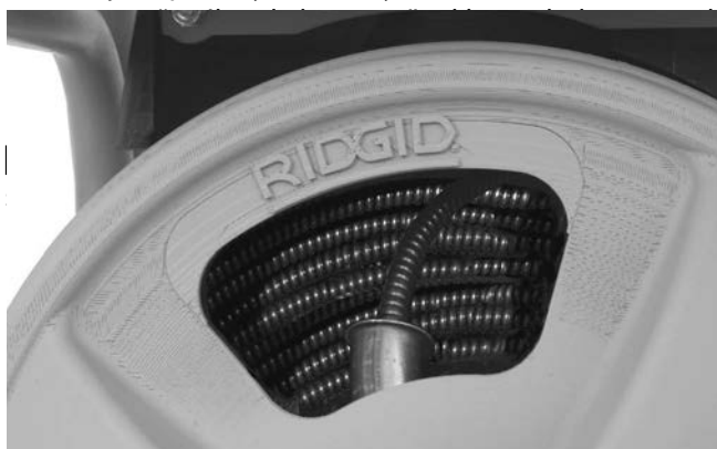
Obrázek 17 – Zobrazeným způsobem naviňte kabel do bubnu
