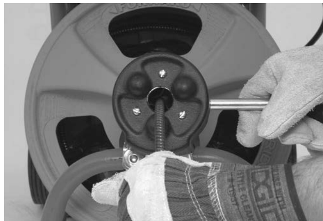
Figura 14 – AUTOFEED în poziție recuperare
