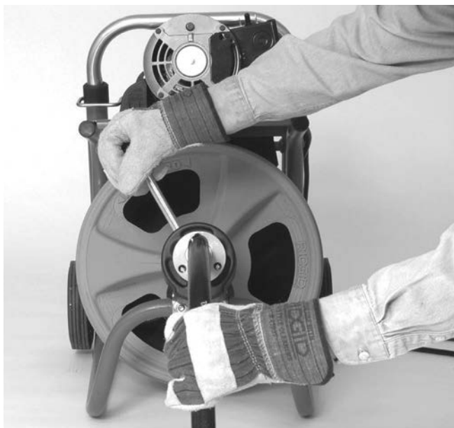
15-сурет – Машинаны бағыттағыш білікпен пайдалану
