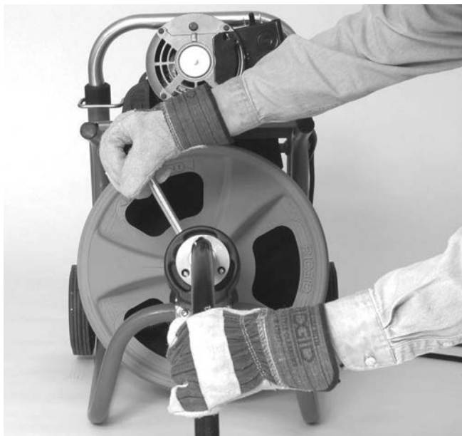
Εικόνα 15 – Χρήση του μηχανήματος με λαστιχένιο οδηγό
