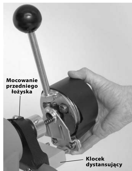
Rys. 4 – Mocowanie MECHANIZMU AUTOFEED na ramie
