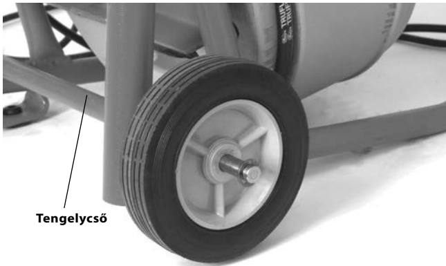
2. ábra – A kerék felszerelése
