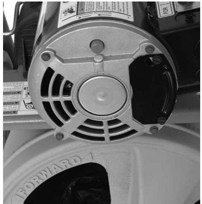
Figure 8 – Flèches de sens de rotation du tambour
