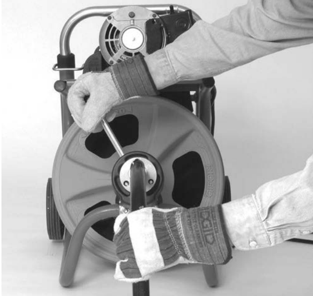
Figuur 15 - Machine gebruiken met geleidingsslang
