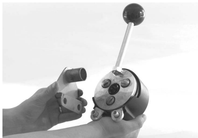
Рисунок 3 – Расположение монтажного кронштейна на AUTOFEED
