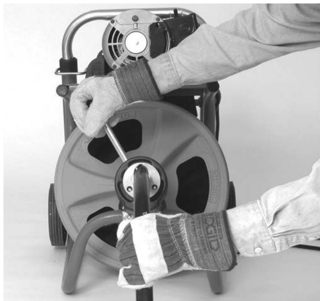
Obrázek 15 – Použití nástroje s vodící hadicí
