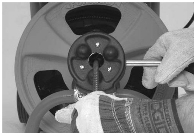
14-сурет – AUTOFEED кері козицияда
