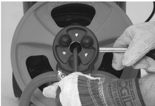
Figur 14 – AUTOFEED i tilbagetrækningsstilling
