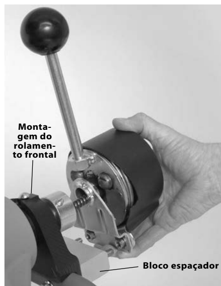
Figura 4 – Montagem AUTOFEED (Avanço automático) na estrutura
