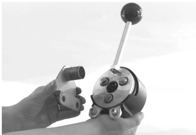
Figura 3 – Colocar o suporte de montagem no AUTOFEED (avanço automático)
