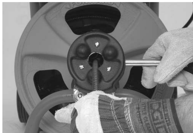
Obrázok 14 – Mechanizmus AUTOFEEDv polohe vyťahovania
