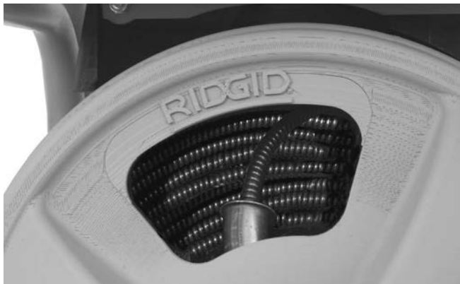
Figura 17 – Avvolgere il cavo nel tamburo come raffigurato
