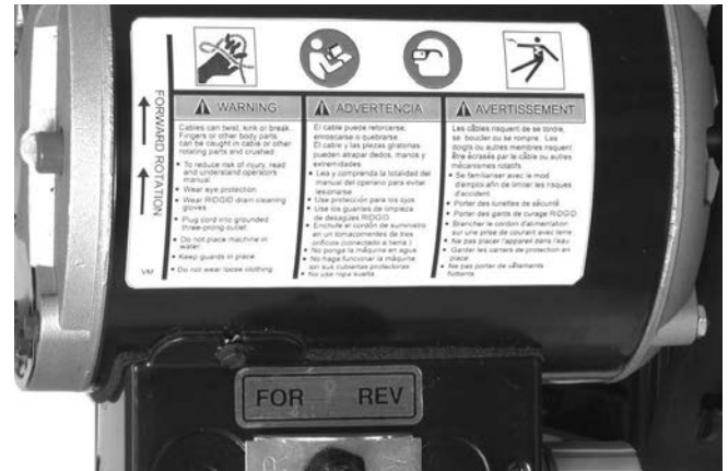
Εικόνα 7 – Ετικέτα προειδοποίησης – Κινητήρας
