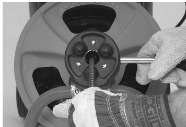
Figura 14 – AUTOFEED (avanço automático) em posição de recolha
