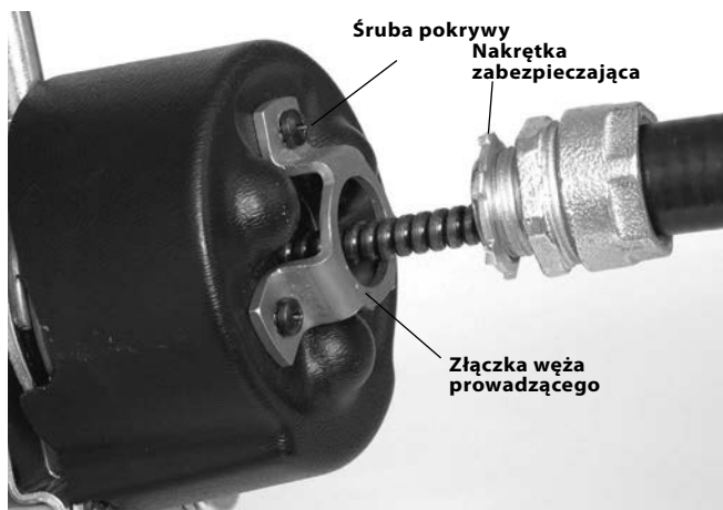
Rys. 5 – Mocowanie węży prowadzącego do mechanizmu AUTOFEED
