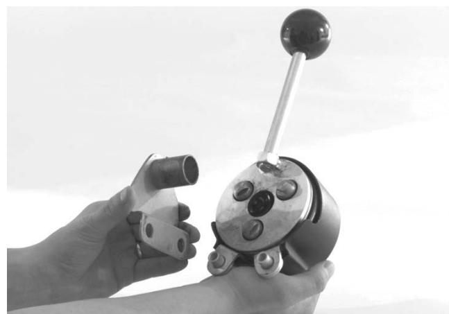
Rys. 3 – Zakładanie wspornika mocującego na mechanizmie AUTOFEED
