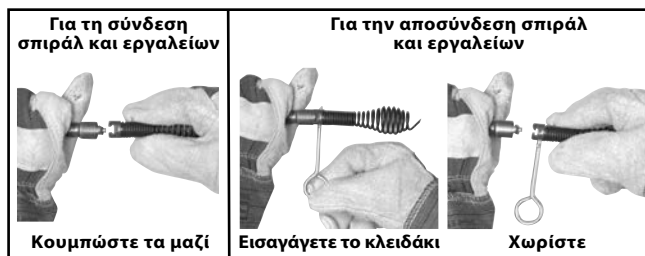
Εικόνα 11 – Σύνδεση και αποσύνδεση εργαλείων
