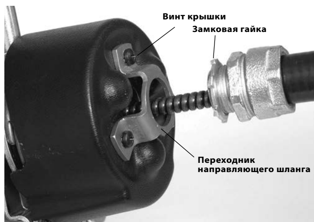
Рисунок 5 – Монтаж направляющего шланга на AUTOFEED
