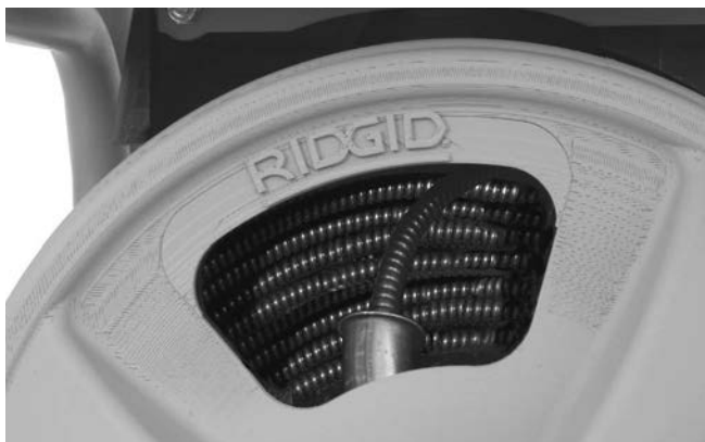
17-сурет – Кабельді барабанға суретте көрсетілгендей орап салыңыз
