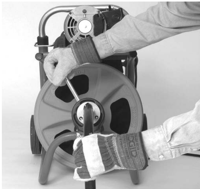
Slika 15 – Uporaba stroja z vodilno cevjo
