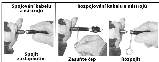
Obrázek 11 – Připojení a odpojení nástroje
