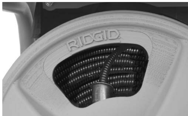
17. ábra – A kábelt az ábra szerint kell a dobba tekerceselni
