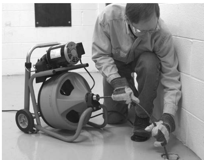
Obrázek 12 – V provozní poloze, ruční zasouvání kabelu
