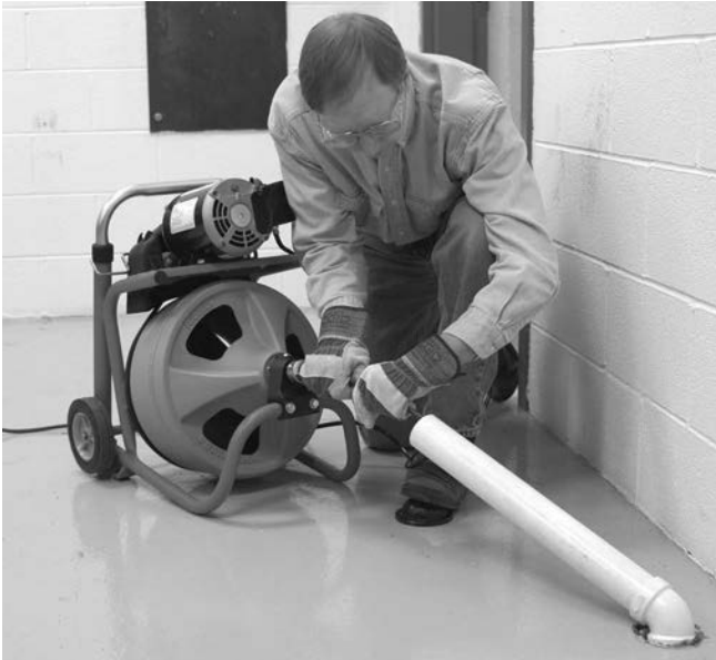
Şekil 9 – Kanalin Kanal Açıklığından 2' İçinde Uzatılması Örneği
