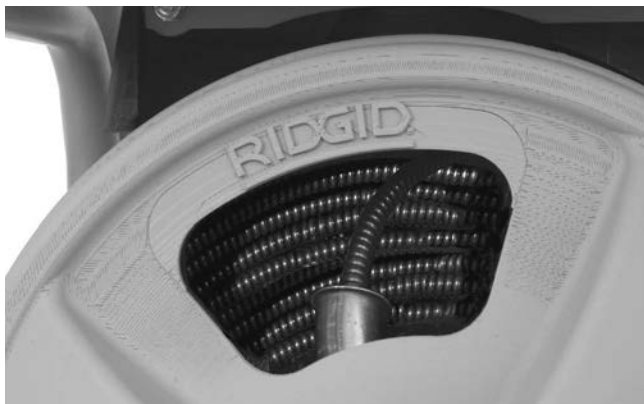
Rys. 17 – Ustawienie sprężyny w bębnie
