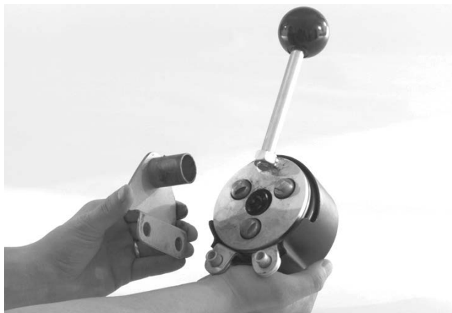
Figura 3 – Posizionamento della staffa di montaggio all'AUTOFEED
