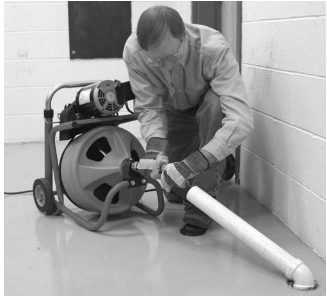
9-сурет – Ағын құбыры аузынан 2 дюйм жерге дейін ағын құбырын созу мысалдары
