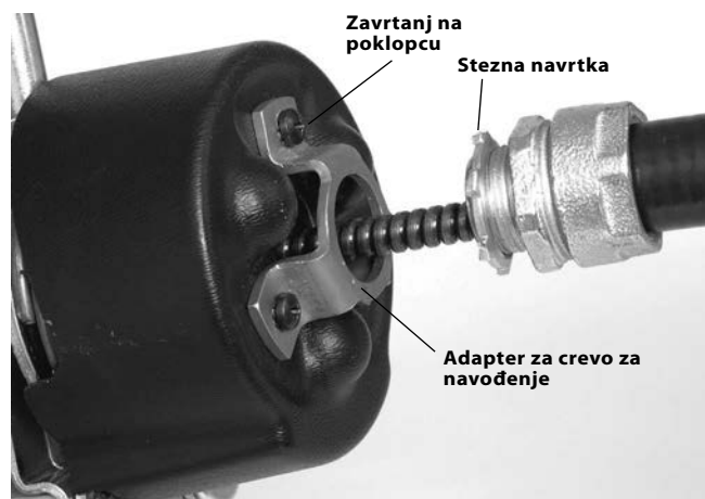
Slika 5 – Montiranje creva za navođenje na AUTOFEED
