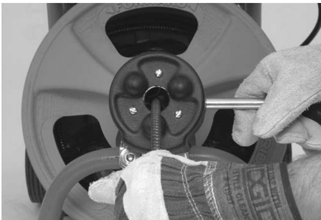
Obrázek 14 – AUTOFEED v poloze zasouvání
