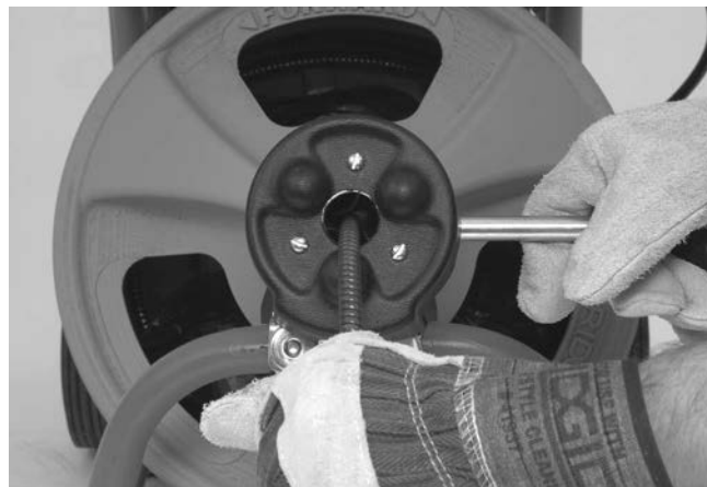
14. ábra – AUTOFEED előtolás visszahúzási pozícióban
