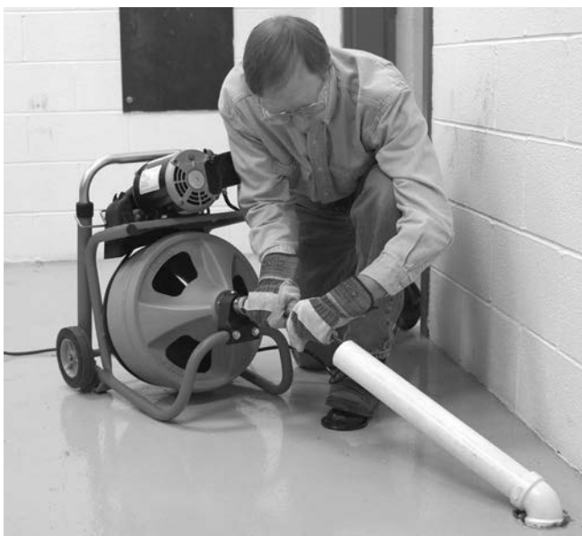
Slika 9 – Primer podaljšanja odtoka do 2' od odprtine bobna
