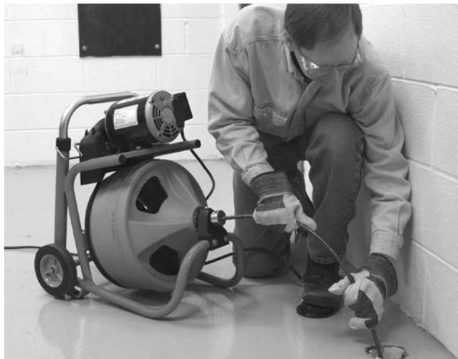
12. ábra – Üzemi pozícióban, kézi kábelelőtolással
