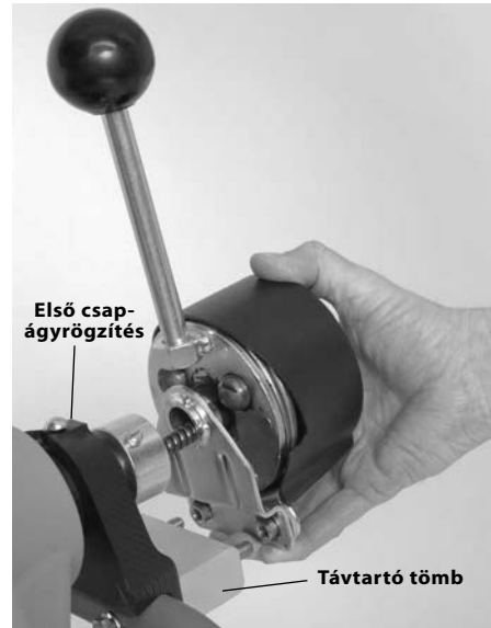
4. ábra – Az AUTOFEED felszerelése a keretre
