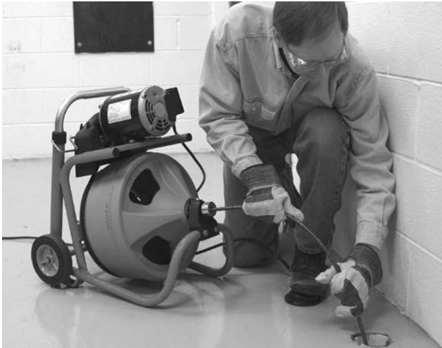
Rys. 12 – W położeniu roboczym, ręczne wprowadzanie sprężyny
