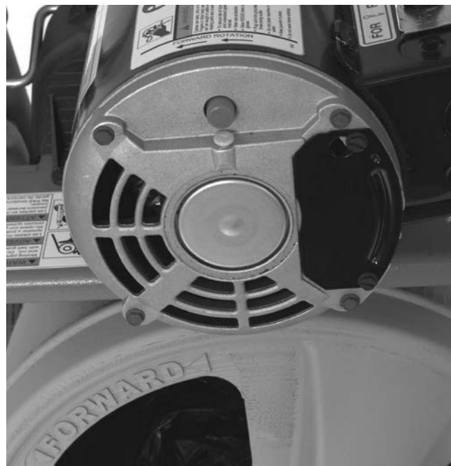
Figura 8 – Setas de direcção de rotação do tambor
