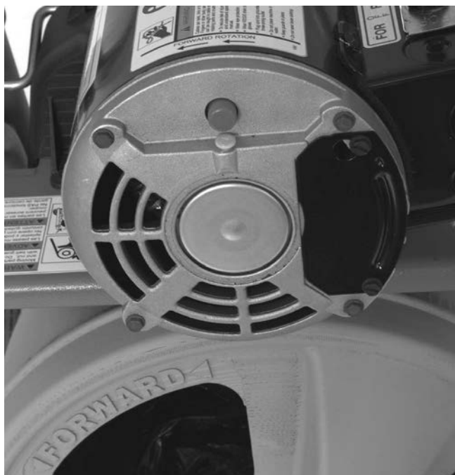
Рисунок 8 – Стрелки, указывающие направление вращения барабана
