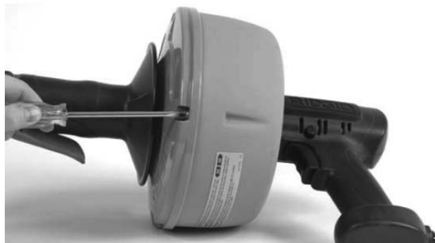
Figura 6 – Afrouxe os Quatro (4) Parafusos da Metade Traseira do Recolhe-cabos Cerca de Três (3) Voltas Completas
