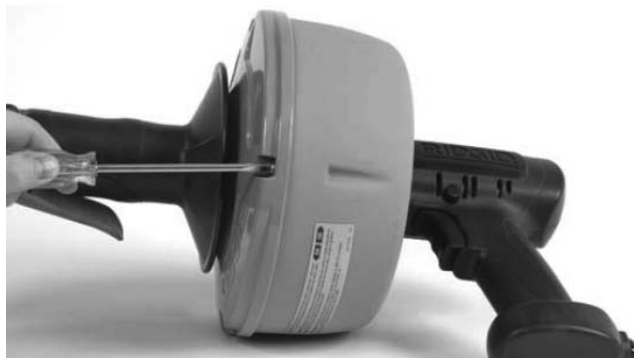
Figur 6 – Løsn de fire (4) skruer i den bageste del af beholderen ca. tre (3) hele omdrejninger
