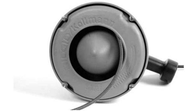
Figuur 7A – Wanneer u veer in een binnentrommel naar binnen voert, dient u de veer in wijzerzin op te winden
