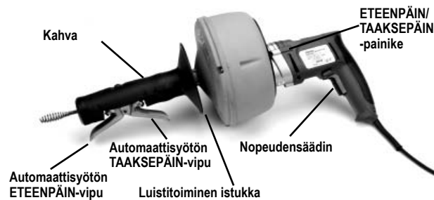
Kuva 1 – Viemäriputken puhdistin K-39AF
