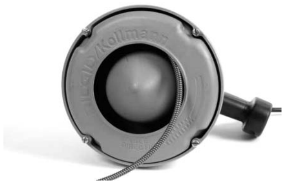
Figura 7A – Când încărcați cablul pe un tambur interior, înfășurați cablul în sensul acelor de ceasornic
