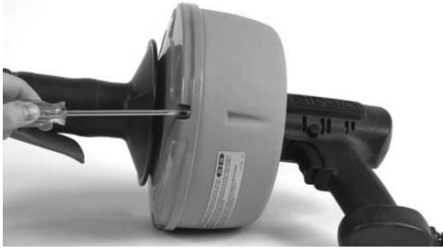
Εικόνα 6 – Αασκάρετε τις τέσσερις (4) βίδες στο πίσω τμήμα του κελύφους κατά τρεις (3) πλήρεις στροφές
