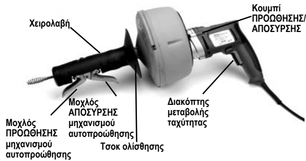
Εικόνα 1 – Μηχάνημα Απόφραξης Αποχετεύσεων K-39AF
