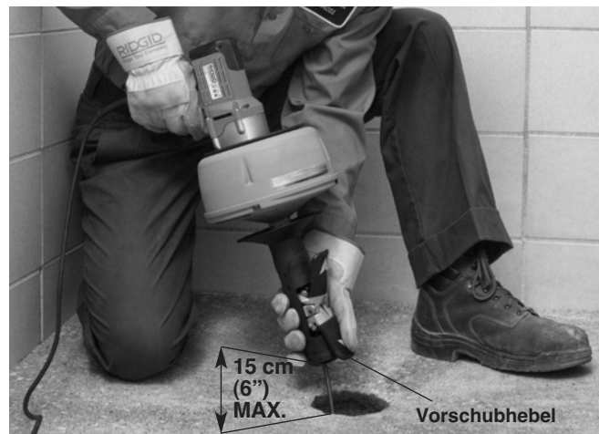
Abbildung 10 – Vorwärtsschieben der Spirale mit AUTOFEED
