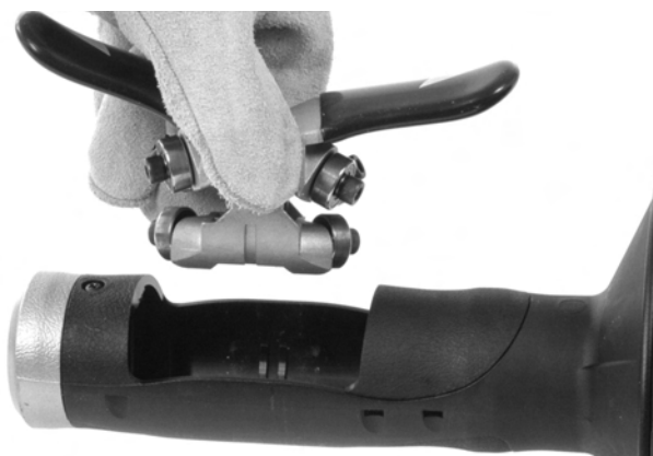
Slika 12B – Skidanje AUTOFEED mehanizma sa kućišta
