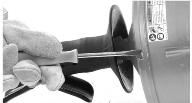
Figura 13 – Allentare le 4 viti del tamburo di circa 3 giri completi, ma non rimuoverle
