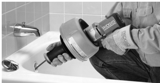
Figure 9 – Pousser le câble dans la conduite
