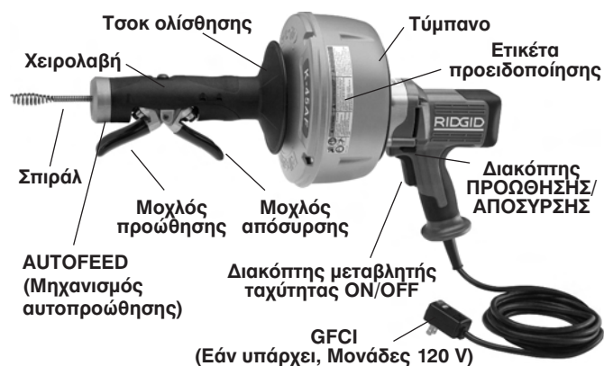
Εικόνα 2 - Μηχάνημα απόφραξης αποχετεύσεων K-45 με AUTOFEED
