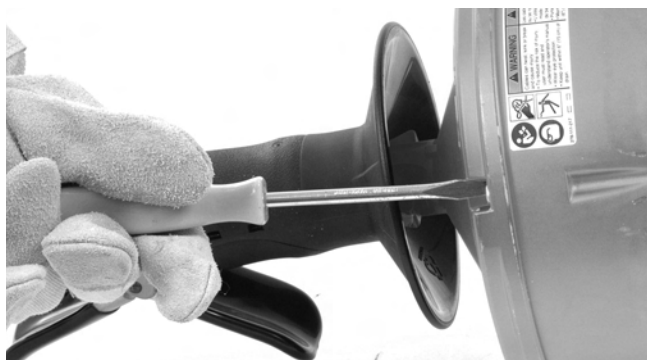
Εικόνα 14 - Περιστρέψτε για να διαχωρίσετε το τύμπανο
