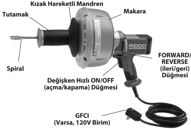
Şekil 1 - Kızak Hareketli Mandreni olan K-45 Kanal Temizleme Makinesi
