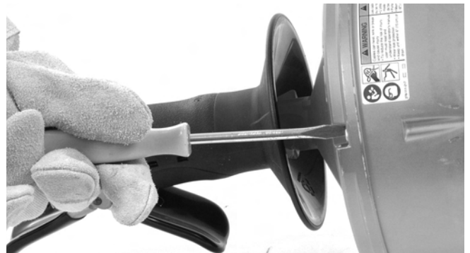
Obrázok č. 13 – Uvoľnite 4 skrutky bubna o 3 celé otáčky, ale nevyberajte ich
