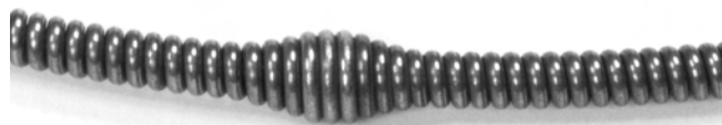
Figura 11 – Cablu C-13-IC SB cu indicator al capătului cablului Proeminența este la aprox. 2,1 m (84") de capătul din spate al cablului
