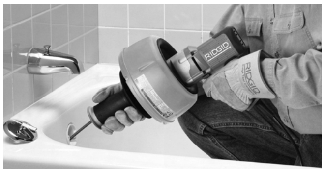
Slika 9 – Kabel potisnite v odtok
