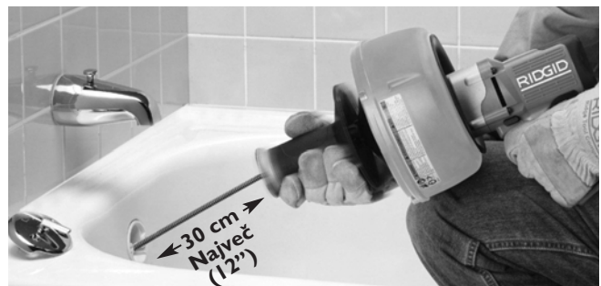
Slika 8 – Ročaj premaknite proti bobnu, da primete kabel z vpenjalno glavo
