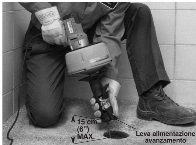
Figura 10 – Alimentazione del cavo in modalità AUTO-FEED
