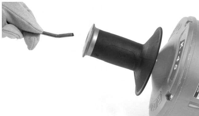
Figura 17 – Încărcarea cablului fără schimbarea tamburului interior
