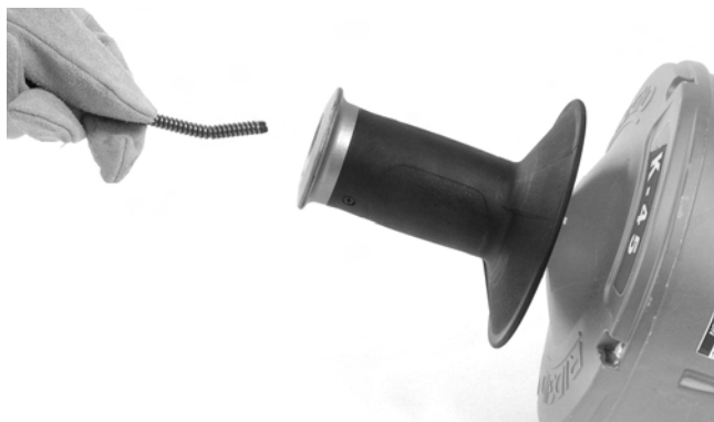
Figur 17 – Ladda spiral utan att byta innertrumman
