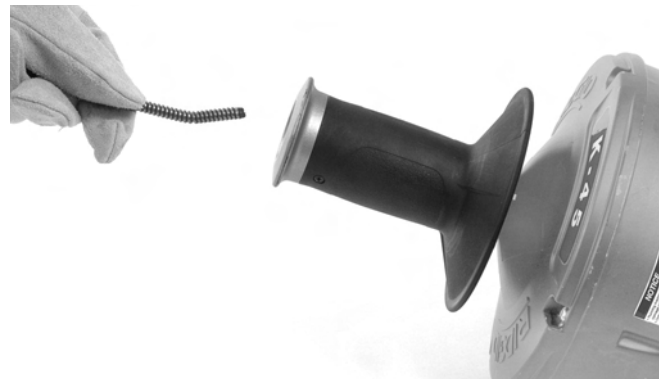
Kuva 17 – Jousen lataaminen vaihtamatta sisäkela
