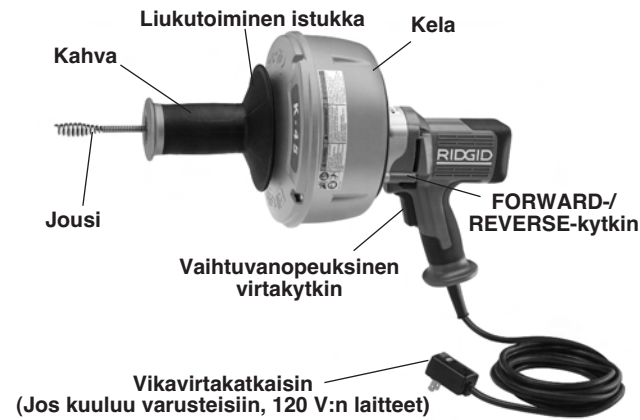
Kuva 1 – K-45 liukutoimisella istukalla varustettu viemärinavauslaite
