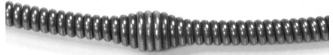
Şekil 11 – Spiral Uç Göstergesi Hız Tümseği, Spiralin Arka Ucundan Yaklaşık 2,1 m (84") Mesafede C-13-IC SB Kablo
