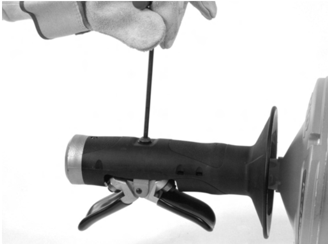
Figura 12A – Rimozione della vite AUTOFEED
