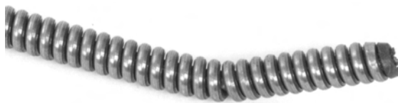
Figur 15 – Böj i spiralens ände
