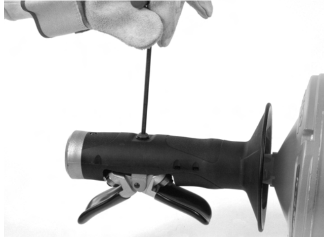
Εικόνα 12A - Αφαίρεση βίδας μηχανισμού AUTOFEED
