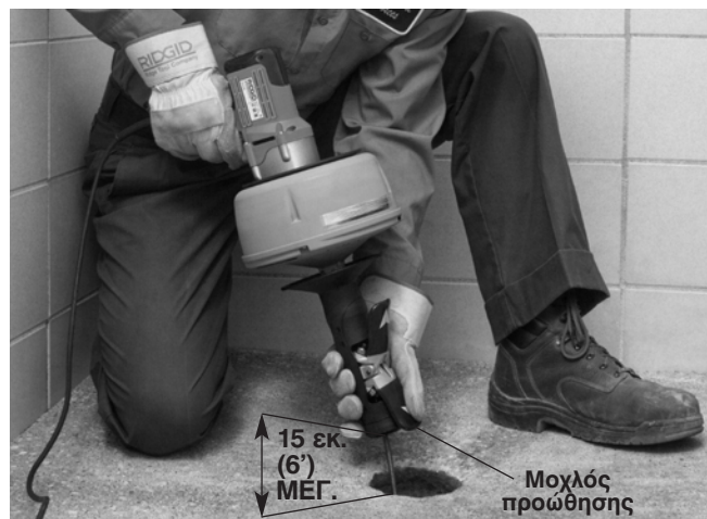
Εικόνα 10 - Προώθηση σπιράλ με AUTOFEED
