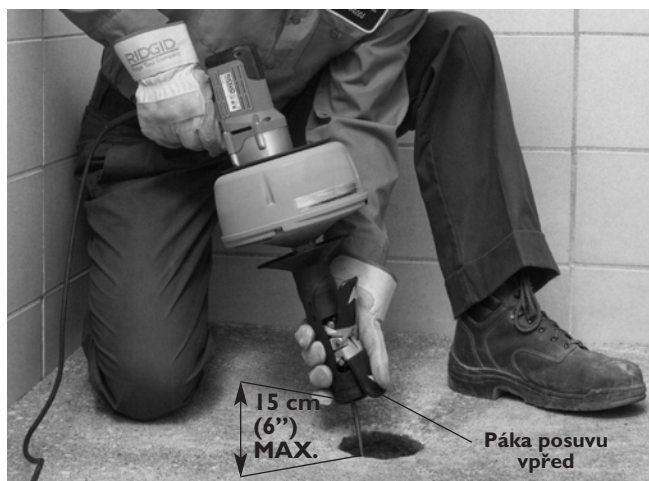
Obrázek 10 – Zasouvání kabelu AUTOPOSUVEM
