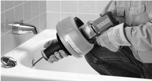
9. ábra – Tolja a lefolyóba a kábelt
