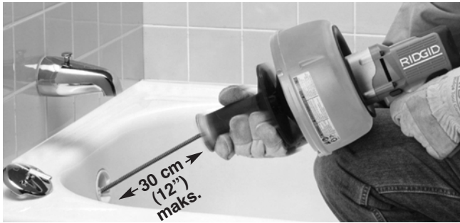
Figur 8 – Flyt håndgrebet mod tromlen for at gribe spiralen med patronen
