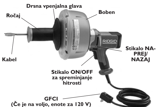
Slika 1 – Naprava za čiščenje odtokov K-45 z drsno vpenjalno glavo
