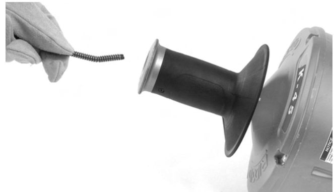
Şekil 17 - İç Makarayı Değiştirmeden Spiralin Yüklenmesi
