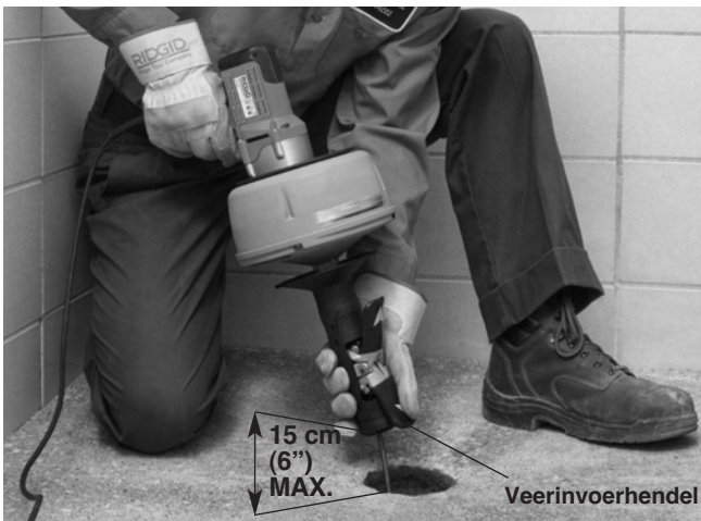
Figuur 10 – Veer invoeren met AUTOFEED
