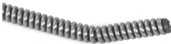
Obrázek 15 – Ohyb na konci kabelu
