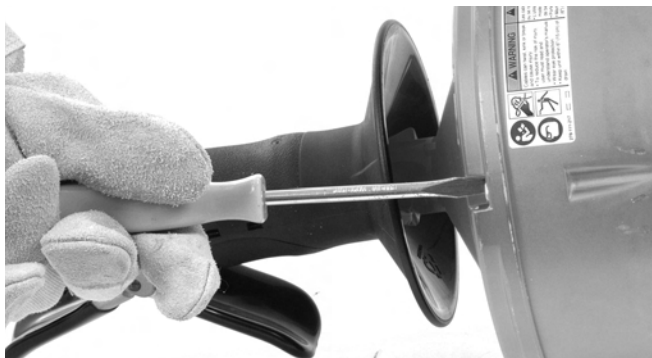
Obrázek 13 – Povolte 4 šrouby bubnu o asi 3 celé otáčky, ale nevyšroubovávejte je úplně
