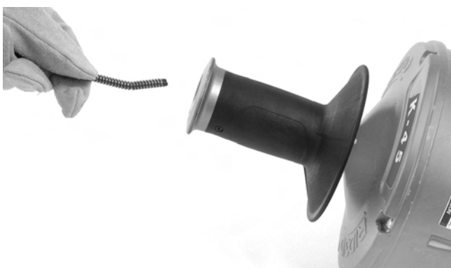
Obrázek 17 – Ukládání kabelu bez výměny vnitřního bubnu
