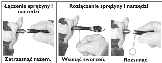
Rysunek 7 – Przyłączanie i odłączanie narzędzi
