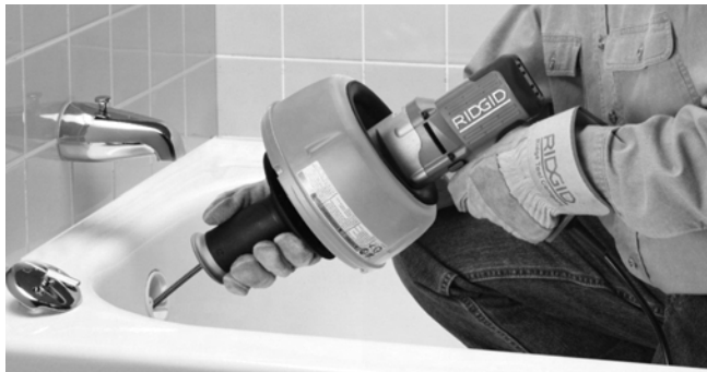
Kuva 9 – Työnnä jousi sisään viemäriin
