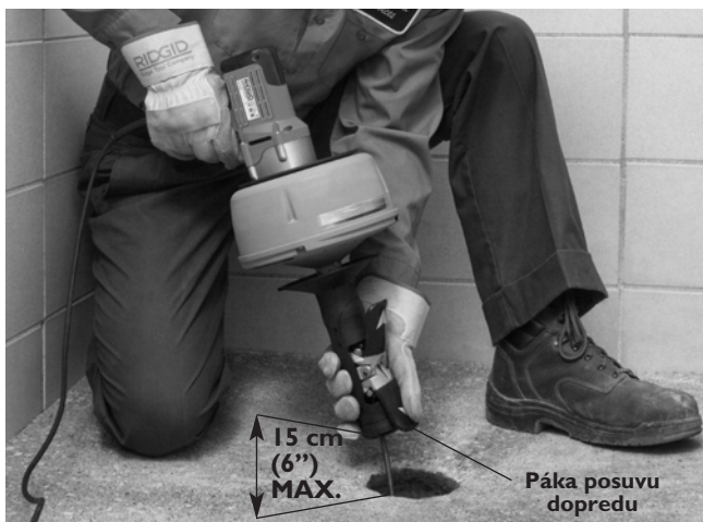
Obrázok č. 10 – Zasúvanie kábla v režime AUTOFEED
