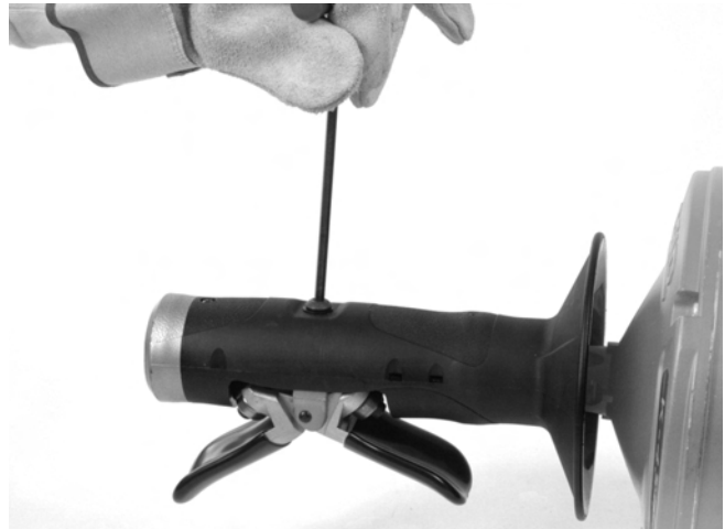
Figura 12A – Extracción del tornillo de la AUTOFEED
