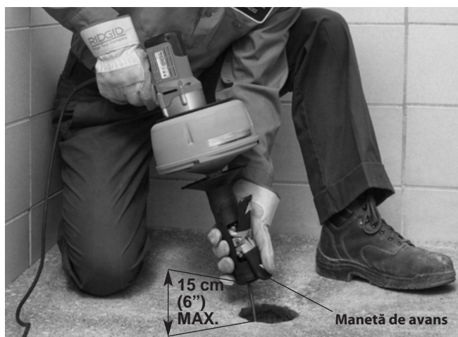
Figura 10 – Avansarea cablului cu AUTOFEED
