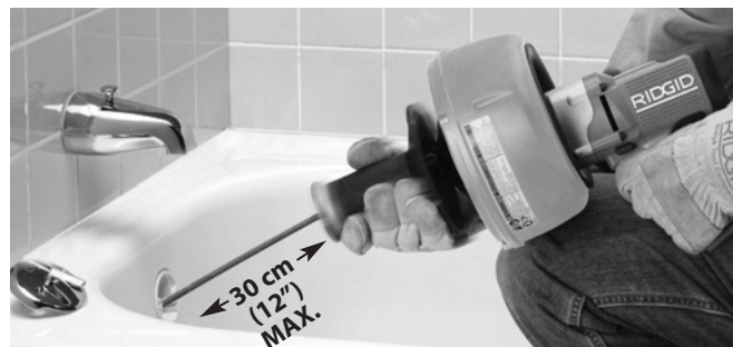
Figura 8 – Mișcați mânerul spre tambur pentru a prinde cablul cu mandrina
