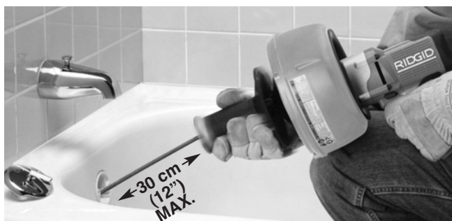
Kuva 8 – Tartu jouseen istukan avulla siirtämällä kahvaa kohti kelaa
