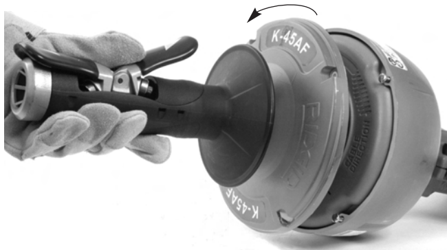
Figura 14 – Desfacerea tamburului prin răsucire
