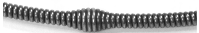
Obrázok č. 11 – Kábel C-13-IC SB so značkou konca kábla (Speedbump). Značka sa nachádza vo vzdialenosti cca 2,1 m (84") pred koncom kábla
