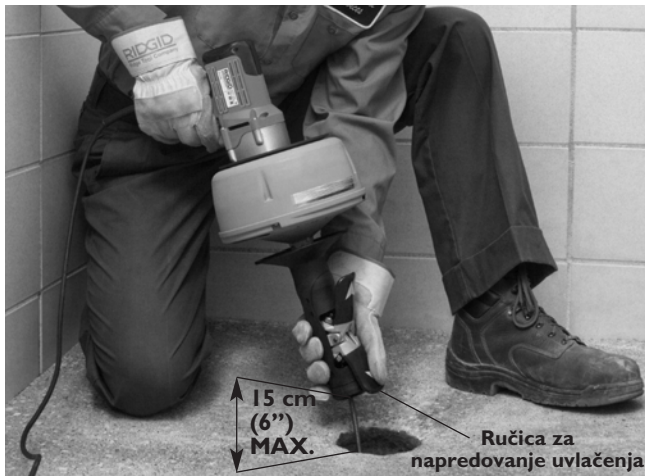
Slika 10 – Uvlačenje sajle korišćenjem AUTOFEED jedinice
