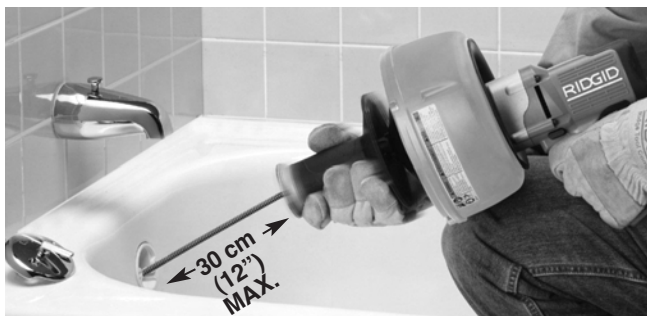
Figur 8 – Flytta handtaget mot trumman för att greppa vajern med chucken
