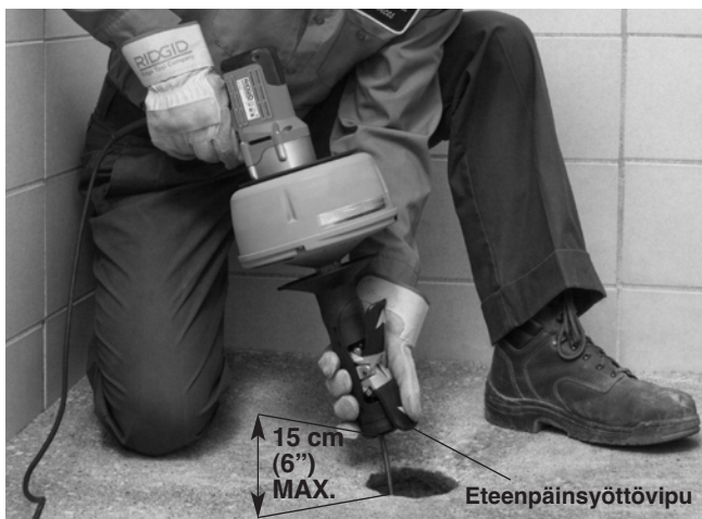
Kuva 10 – Jousen syöttäminen AUTOFEED-toiminnolla
