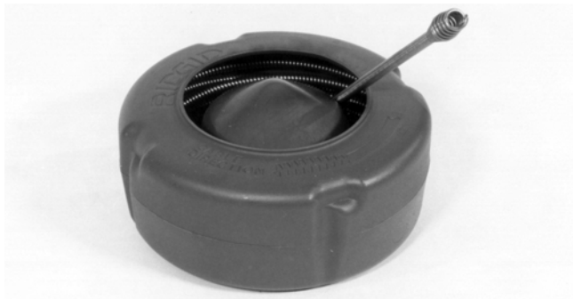
Obrázek 16 – Navíjení kabelu do vnitřního bubnu; kabel navíjete VE SMĚRU CHODU HODINOVÝCH RUČIČEK
