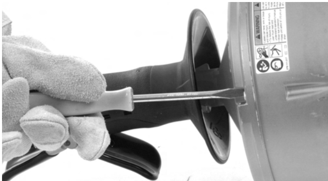
Figura 13 – Slăbiți cele 4 șuruburi de tambur cu circa 3 ture complete, dar nu le scoateți
