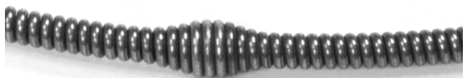
Figuur 11 – C-13-IC SB veer met veereinde-indicator. De “verkeersdrempel” bevindt zich ong. 2,1 m van het achterste veeruiteinde
