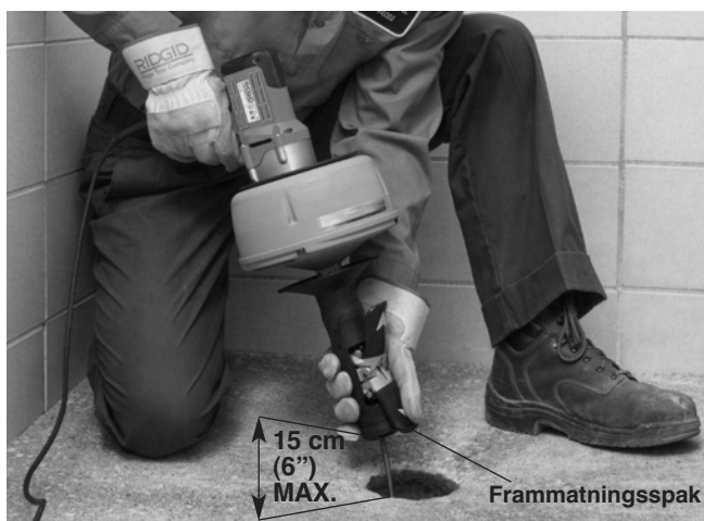
Figur 10 – Mata fram spiralen med AUTOFEED
