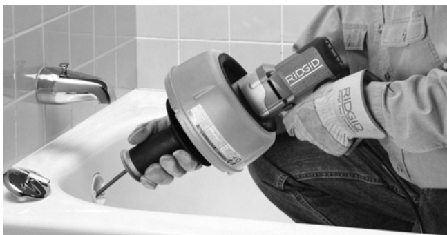
Figur 9 – Skjut spiralen längs avloppsledningen
