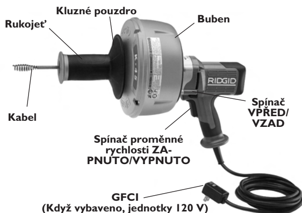
Obrázek 1 – Přístroj na čištění kanálů K-45 s kluzným pouzdem
