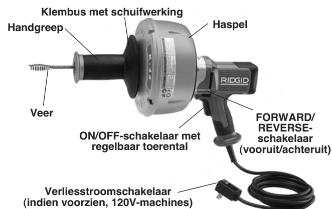
Figuur 1 – K-45 Afvoerontstoppingsmachine met klembus met schuifwerking
