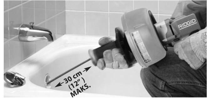
Şekil 8 - Spirali Kavramak için Tutamağı Makaraya Yaklaştırın
