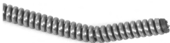
Rysunek 15 – Zgiąć przy końcu sprężyny
