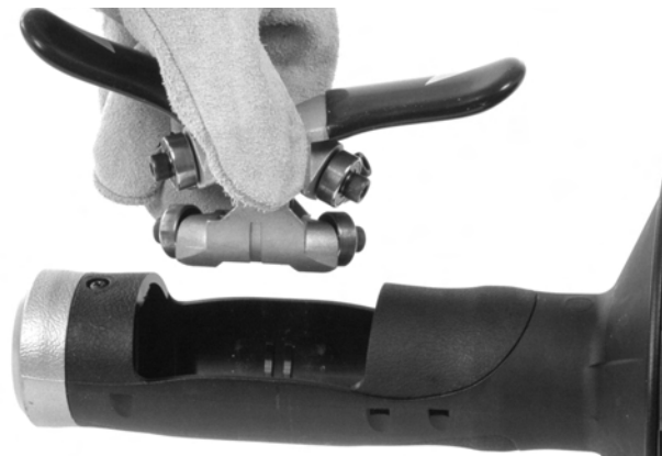
Εικόνα 12B - Αφαίρεση μηχανισμού AUTOFEED από το περίβλημα
