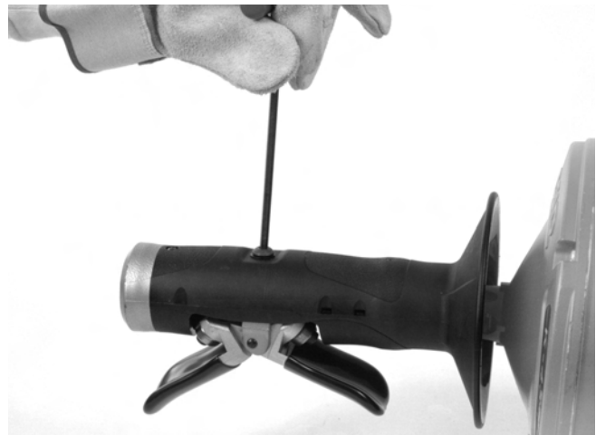
Figuur 12A – Verwijderen van AUTOFEED-schroef
