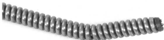
Figura 15 – Piega all'estremità del cavo
