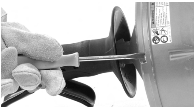
Figur 13 – Løsne 4 trommelskruer omkring 3 hele omdreininger, men ikke fjern dem
