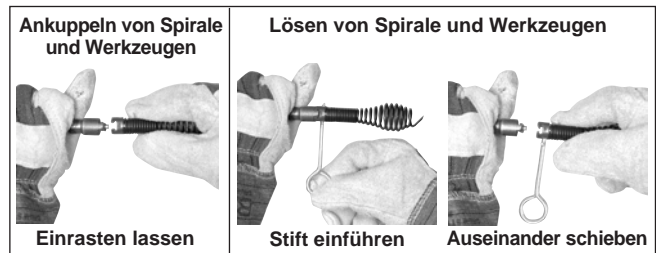
Abbildung 7 – Anschließen und Lösen von Werkzeugen
