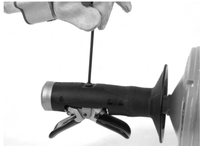
Figur 12A – Fjerning av AUTOFEED-skrue
