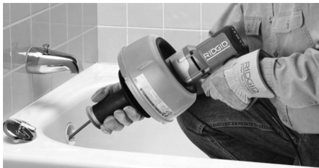
Slika 9 - Gurnite sajlu niz odvod
