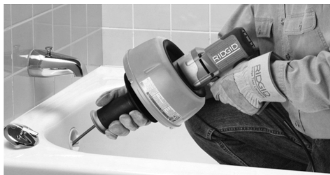
Slika 9 – Guranje sajle duž odvodne linije
