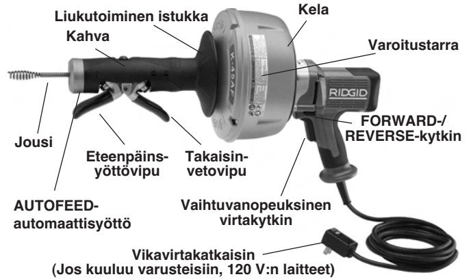
Kuva 2 – K-45 AUTOFEED-automaattisyötöllä varustettu viemärinavauslaite
