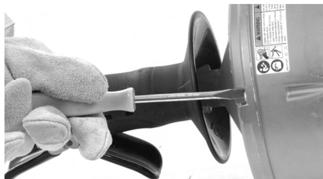
Rysunek 13 - Poluzować 4 śruby bębna o 3 pełne obroty, ale nie wykręcać
