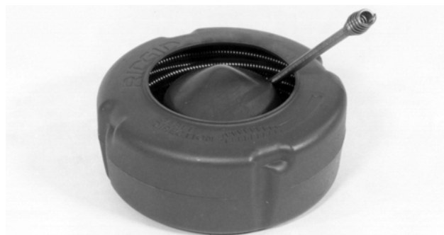
Figure 16 – Enrouler le câble dans le tambour interne EN SENS HORAIRE
