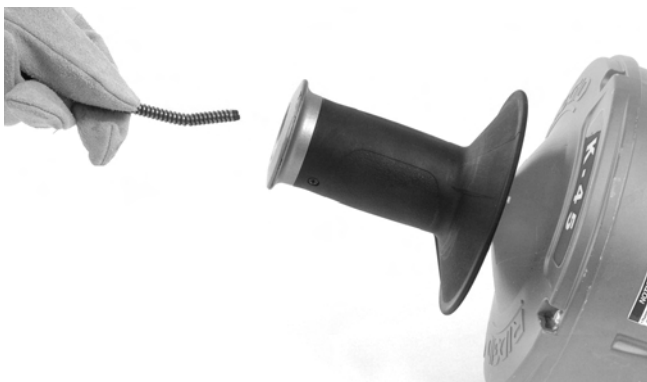
Figur 17 – Indføring af spiralen uden at skifte indertromlen
