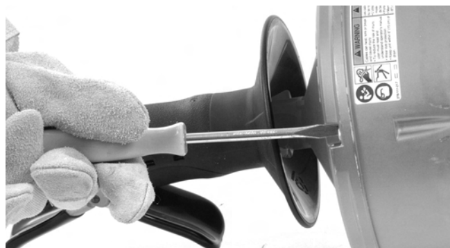
Figura 13 – Desapertar os 4 parafusos do tambor cerca de 3 voltas completas, mas sem os retirar
