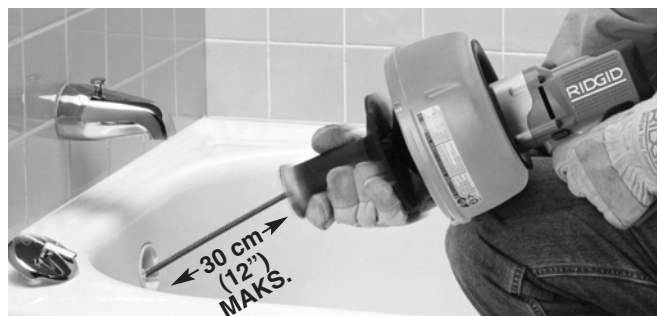
Figur 8 – Flytt håndtaket mot trommelen for å ta tak i kabelen med kjoksen
