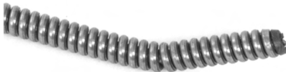
Figura 15 – Curbura de la capătul cablului.
