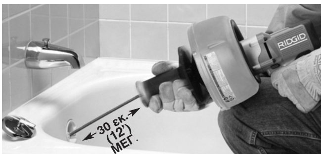
Εικόνα 8 - Μετακινήστε τη χειρολαβή προς το τύμπανο για να πιάσετε το σπιράλ με το τσοκ
