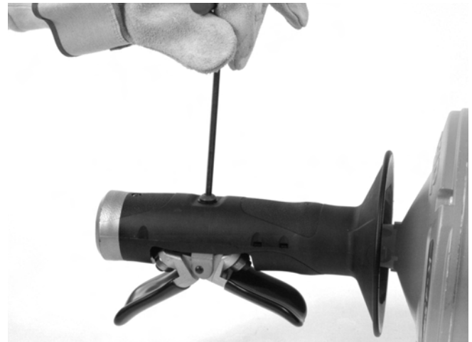
Figur 12A – Ta bort AUTOFEED-skruven
