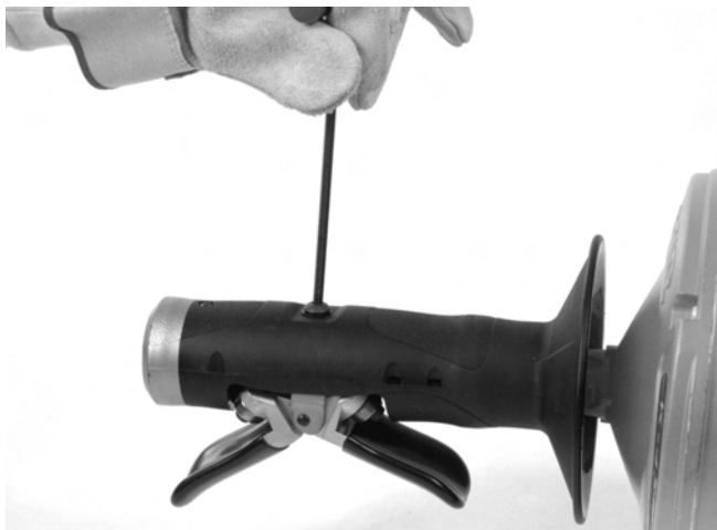
Obrázok č. 12A – Demontáž skrutky mechanizmu AUTOFEED
