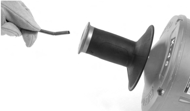
Εικόνα 17 - Τοποθέτηση σπιδράλ χωρίς αλλαγή του εσωτερικού τύμπανου
