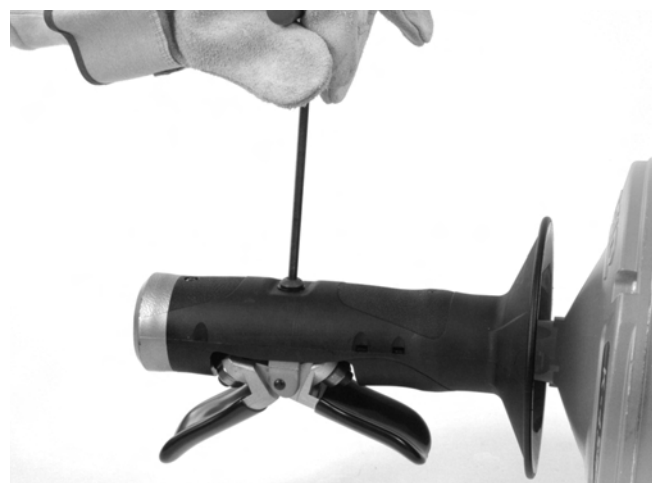
Obrázek 12A - Odšroubování šroubu AUTOPOSUVU
