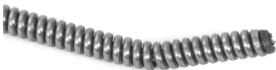
Slika 15 – Upogib na koncu kabla
