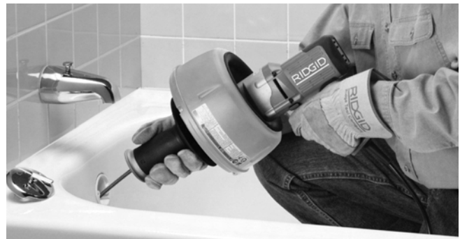
Рис. 9 – Протолкните трос дальше в канализационную трубу
