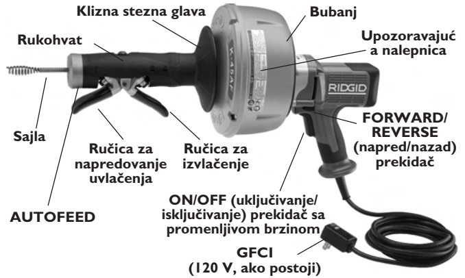
Slika 2 – K-45 Mašina za čišćenje odvoda sa AUTOFEED jedinicom
