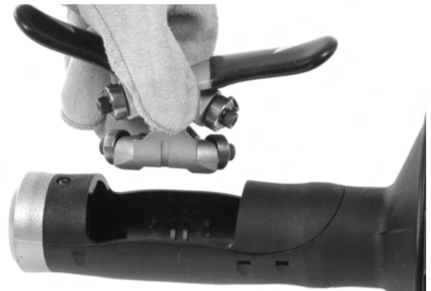
Figura 12B – Demontarea mecanismului AUTOFEED din carcasă
