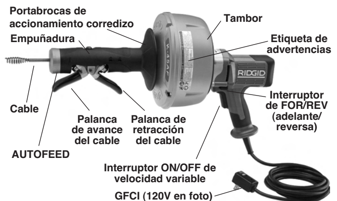
Figura 2 – Limpiadora de desagües K-45 AF con AUTOFEED
