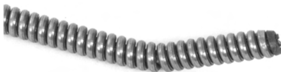
Figur 15 – Bøy på kabelenden
