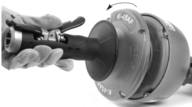
Figure 14 – Ouverture du tambour
