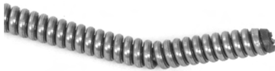
15. ábra – Megtörés a kábelvégnél
