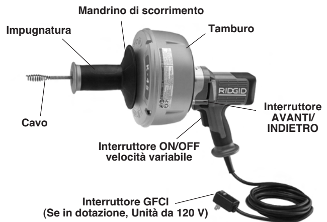
Figura 1 – Macchina stasatrice K-45 con mandrino di scorrimento
