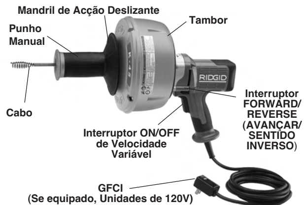
Figura 1 – Máquina de Limpeza de Tubagens K-45 Com Mandril de Acção Deslizante
