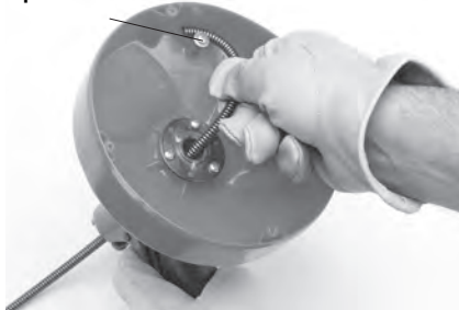
Obrázok č. 9 - Montáž koncovky kábla do držiaka
