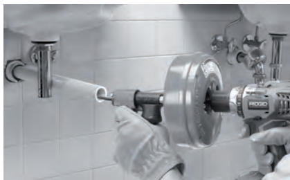
Obrázok č. 7 – Príklad predĺženia odtoku do vzdialenosti 4" (100 cm) od otvoru bubna
