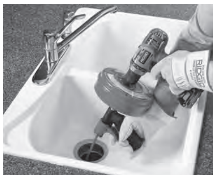
Figur 8A – Använda Power-Spin med en batteridrivna bormaskin
