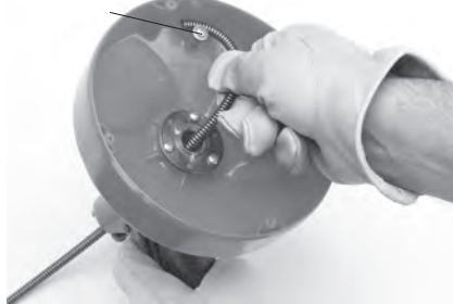
Рис. 9 – Установка конца спирали в держатель
