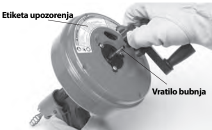
Slika 2 – Uklanjanje ručice za obrtanje sa Power-Spin-a
