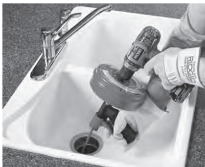
Obrázok č. 8A - Prevádzka čističky Power-Spin s akumulátorovou vrtačkou
