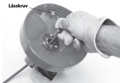
Figur 9 – Spiraländan monteras i hållaren
