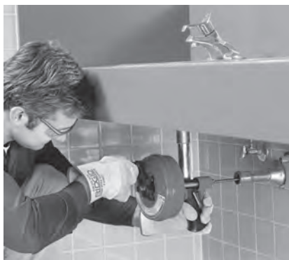
Kuva 8 – Power-Spin käsin käytettynä
