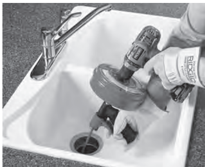
Figura 8A – Power-Spin utilizada com furador a bateria
