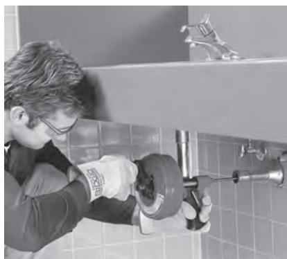
Slika 8 – Power-Spin sa ručnim pogonom
