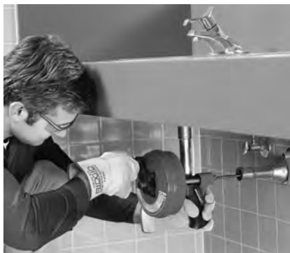
Figura 8 – Uso manual del Power-Spin
