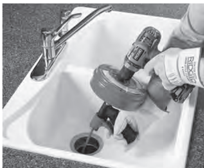
Kuva 8A – Power-Spin akkuporekoneella käytettynä
