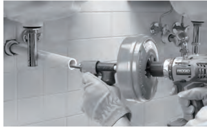
Şekil 7 - Kanal Açıklığının 4" (100 mm) Mesafesine Kanal Genişletme Örneği
