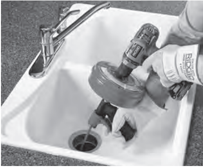
Abbildung 8A – Power-Spin mit Akkubohrmaschine angetrieben
