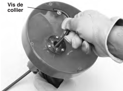
Figure 9 – Engagement du câble dans la bride
