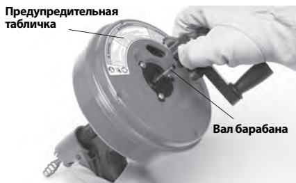
Рис. 2 – Снятие рукоятки с Power-Spin
