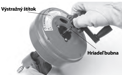
Obrázok č. 2 - Vyberanie rukoväte z čističky Power-Spin
