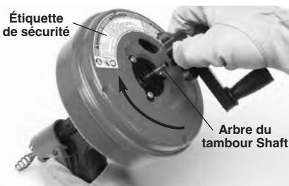
Figure 2 – Retrait de la manivelle du Power-Spin
