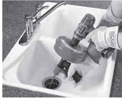
Рис. 8А – Использование Power-Spin с помощью аккумуляторной дрели
