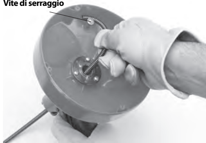
Figura 9 – Installazione dell'Estremità del cavo nel Supporto
