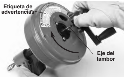
Figura 2 – Extracción de la manivela fuera del Power-Spin
