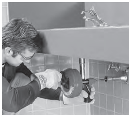
Abbildung 8 – Power-Spin manuell eingesetzt
