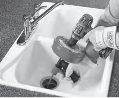
Figuur 8A – Power-Spin aangedreven met snoerloze boormachine
