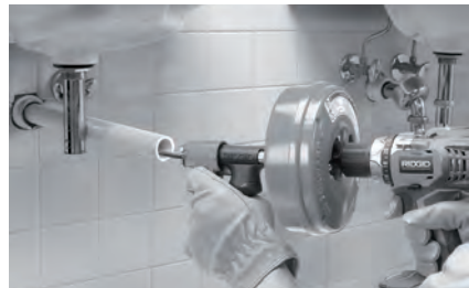
7. ábra – Példa lefolyótoldatra a dobtól számított 4" (100 mm-ig)
