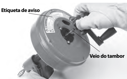
Figura 2 – Remover a pega da manivela da Power-Spin
