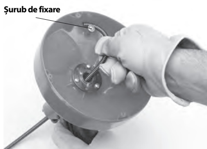
Figura 9 – Instalarea capătului cablului în suport
