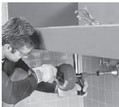
Figura 8 – Power-Spin utilizada manualmente
