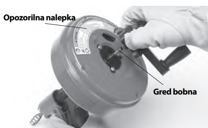
Slika 2 – Odstranjevanje ročice z naprave Power-Spin
