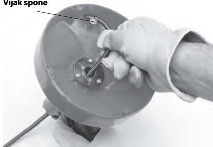
Slika 9 – Namestitev konca kabla v držalo
