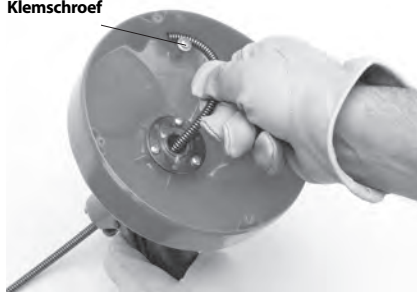
Figuur 9 – Veeruiteinde in de houder bevestigen
