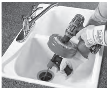
8A ábra – A Power-Spin használata akkumulátoros fúróval
