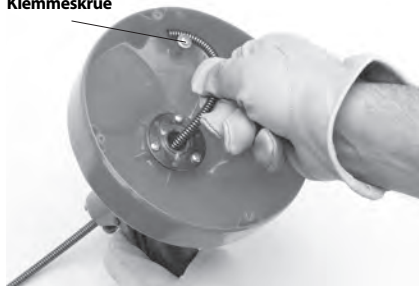
Figur 9 – Installering av kabelenden inn i holderen
