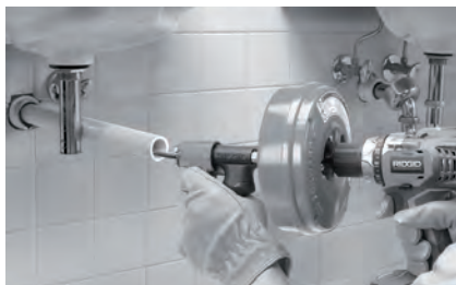
Figuur 7 – Voorbeeld van een verlenging van de afvoer tot minder dan 4" (100 mm) van de afvoeropening
