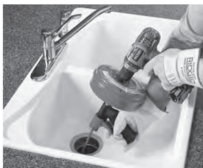
Slika 8A – Power-Spin pogonjen aku bušilicom
