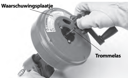
Figuur 2 – De zwengel van de Power-Spin verwijderen
