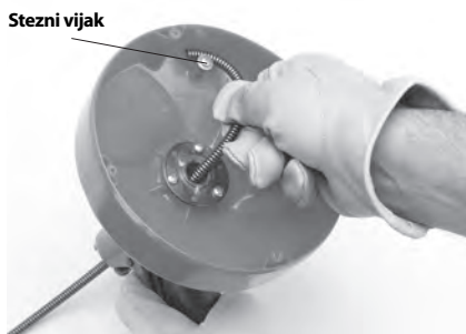
Slika 9 - Ugradnja kraja sajle u držač
