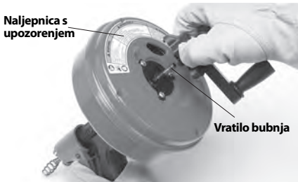
Slika 2 – Skidanje ručice obrtaljke s Power-Spina
