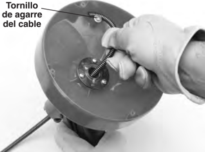
Figura 9 – Sujeción de la cola del cable
