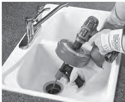
Slika 8A – Uporaba naprave Power-Spin z baterijskim vrtnikom
