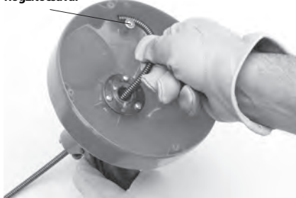
9. ábra – A kábelvég beszerelése a tartóba
