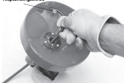
Figur 9 – Montering af spiralenden i holderen
