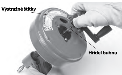
Obrázek 2 – Odstranění držadla kliky z přístroje Power-Spin
