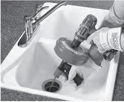
Rysunek 8A – Przepychacz Power-Spin napędzany wkrętarką akumulatorową
