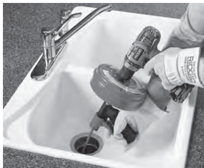
Figura 8A – Power-Spin alimentato con Trapano a batteria
