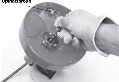
Obrázek 9 – Instalace konce kabelu do držáku
