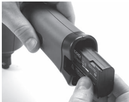
Figur 6 – Sätta in/ta ut batteriet
