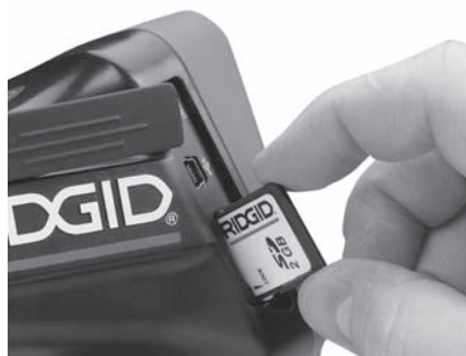
Εικόνα 10 - Εισαγωγή κάρτας SD
