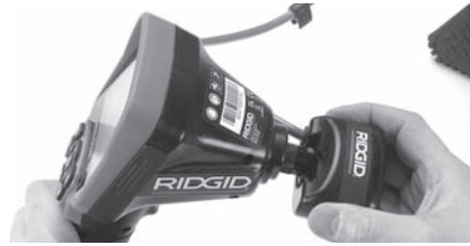
Figura 19 - Ficha do Conector da Câmara Instalada
