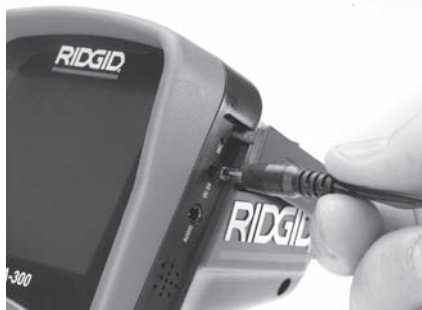
Slika 7 - Napajanje uređaja sa mrežnim adapterom
