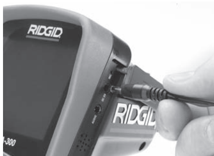
Obrázok č. 7 - Napájanie zariadenie pomocou AC adaptéra
