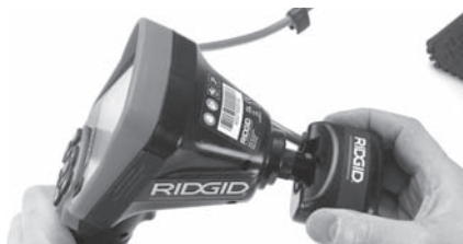
Slika 19 – Nameščen vtič priključka kamere
