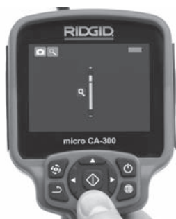
Figur 15 – Justering af lysdioder
