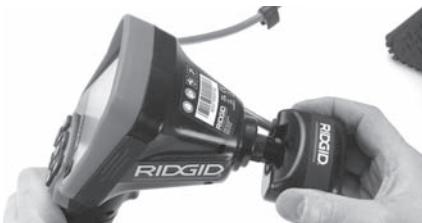
Rys. 19 - Włożony wtyk złącza kamery
