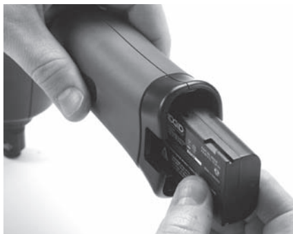
Figura 6 – Remover/instalar a Bateria
