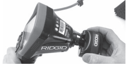
Şekil 19 - Kamera Bağlantı Parçası Fişi Takılı
