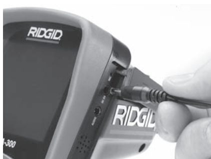
Rys. 7 - Zasilanie z zasilacza prądu zmiennego
