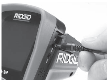
Slika 7 – Napajanje enote z izmeničnim napajalnikom
