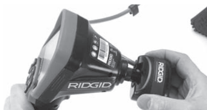
Figura 19 - Spina connettore fotocamera installata
