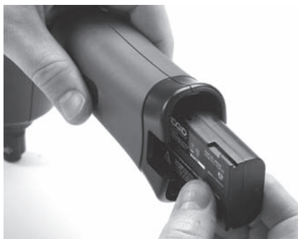
6. ábra – Az akkumulátor eltávolítása/ beszerelése
