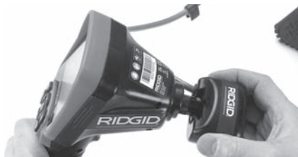
19. ábra – Kamera csatlakozódugója beszerelt állapotban
