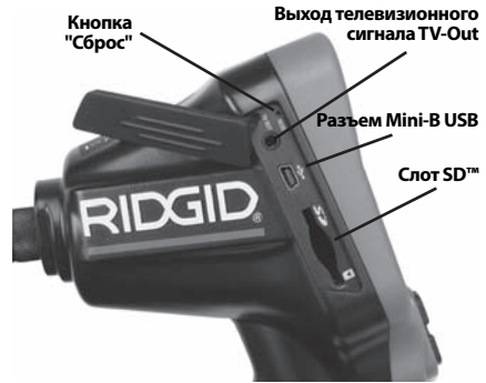
Рис. 4 - Крышка гнезд с левой стороны прибора
