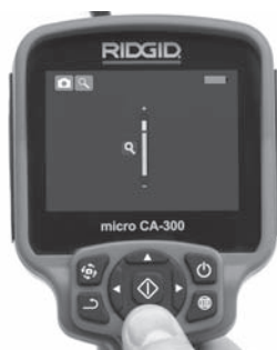
Slika 15 - Podešavanje svjetline LED lampica
