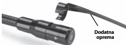
Slika 9 – Namestitev dodatne opreme
