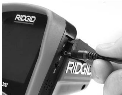
Figura 7 – Alimentación eléctrica del aparato
