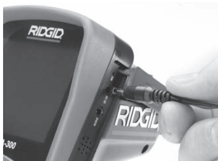
Figur 7 - Strømføring af enheden med AC-adapteren
