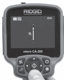
Slika 15 - Podešavanje LED osvetljenja
