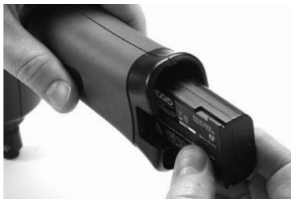
Figura 6 – Extracción e instalación de la batería
