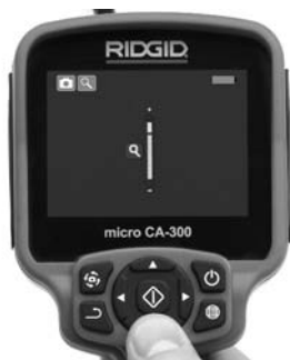
Figure 15 – Réglage des LED
