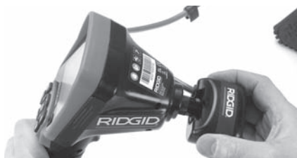
Slika 19 - Ugrađen konektor kamere
