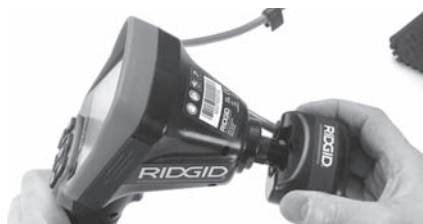
Εικόνα 19 - Βύσμα σύνδεσης κάμερας τοποθετημένο
