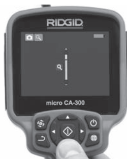
Obrázek 15 – Nastavení LED osvětlení
