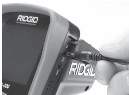
Slika 7 - Napajanje uređaja pomoću AC adaptera
