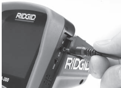
Figura 7 - Alimentarea unității cu adaptorul pentru curent alternativ
