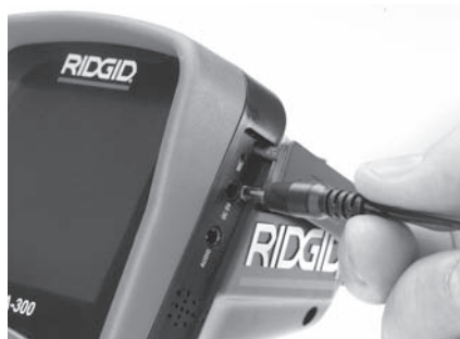
Figur 7 – Driva enheten med nätadaptern
