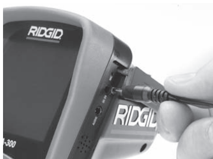
Figuur 7 – Het toestel voeden met AC-adapter
