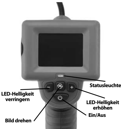
Abbildung 2 – Bedienelemente der Display-Einheit
