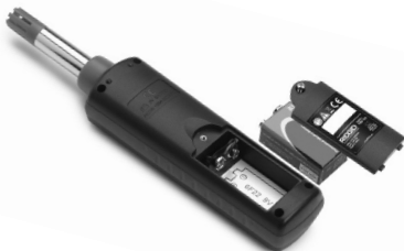
Figure 5 – Remplacement de la pile
