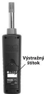
Obr. 2 - Merač teploty a vlhkosti micro HM-100, zadná strana
