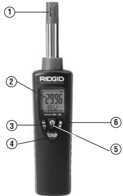
Figura 2 – Dorso del Termohigrómetro micro HM-100
