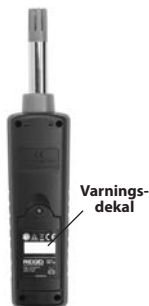
Figur 2 – Baksidan på temperatur- och luftfuktighetsmätaren micro HM-100
