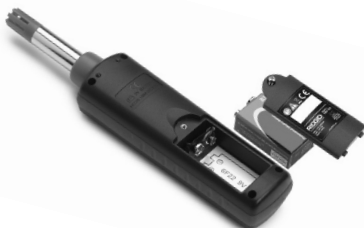
Figura 5 – Reemplazo de la batería
