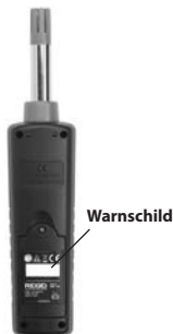
Abbildung 2 – Rückseite des micro HM-100 Temperatur-/Luftfeuchtigkeitsmessers
