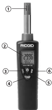
Figura 3 – Comandi del Misuratore di umidità/temperatura micro HM-100
