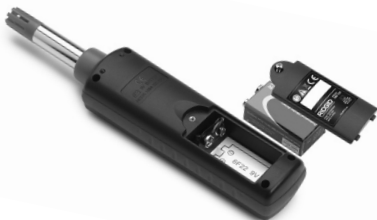
Figura 5 – Sostituzione della batteria
