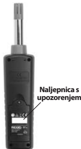
Slika 2 – Poledina termohigrometra micro HM-100
