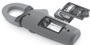
Figura 5 - Substituição da Pilha
