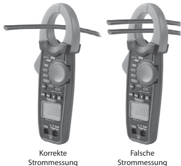
Abbildung 8 – Korrekte Strommessung
