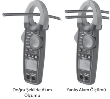
Şekil 8 - Akım Ölçümünün Doğru Şekli
