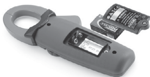
Figura 5 – Sostituzione della batteria
