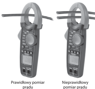
Rys. 8 – Właściwy sposób pomiaru prądu
