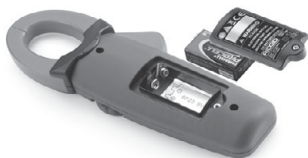
Figuur 5 – Batterij vervangen
