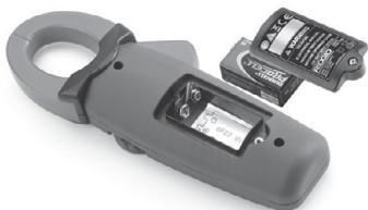
Figura 5 – Reemplazo de la batería
