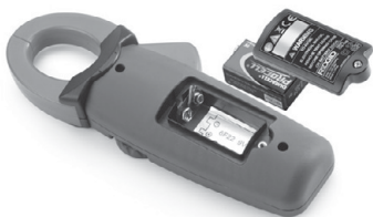
Figure 5 – Remplacement des piles
