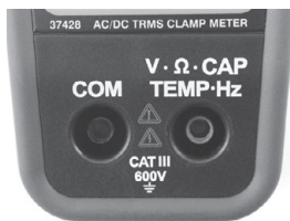
Figura 7 - Terminais de entrada
