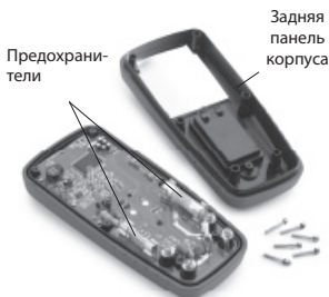
Рис. 9 – Снятие задней панели корпуса
