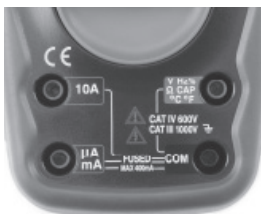
Figura 7 – Terminais de entrada
