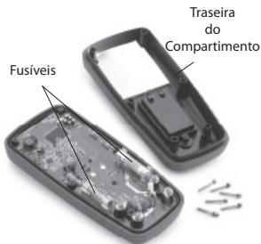
Figura 9 – Retirar a parte traseira do compartimento do multímetro
