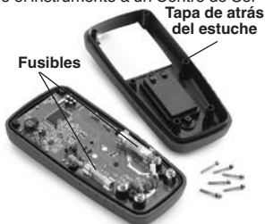
Figura 9 – Extracción de la tapa de atrás del multímetro
