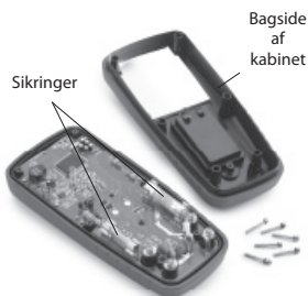
Fig. 9 – Fjernelse af bagsiden af multimeterkabinettet
