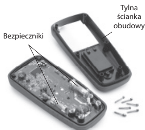
Rys. 9 – Zdejmowanie tylnej ścianki multimetru
