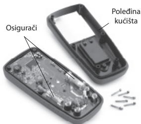
Slika 9 – Uklanjanje pozadine kućišta univerzalnog mernog instrumenta
