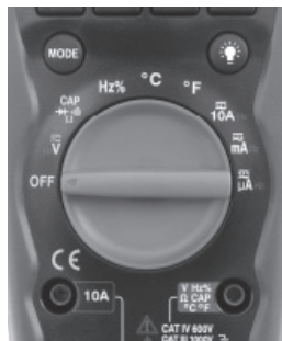
Figura 6 – Selectorul rotativ de funcții
