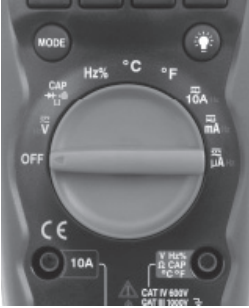
Şekil 6 – Rotari Fonksiyon Düğmesi
