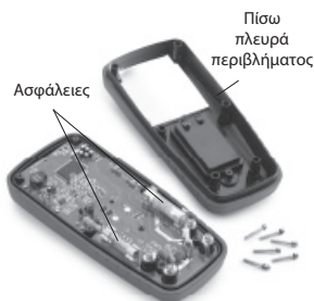
Εικόνα 9 – Αφαίρεση πίσω πλευράς του περιβλήματος πολυμέτρου
