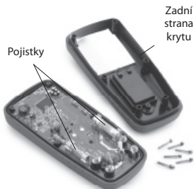
Obrázek 9 – Odstranění zadní strany krytu multimetru
