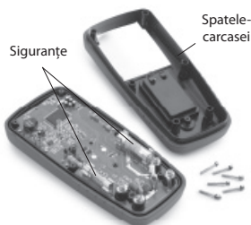
Figura 9 – Scoaterea spatelui carcasei multimetrului
