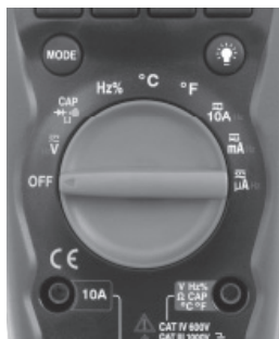
Figura 6 – Interruttore della funzione ruotante
