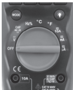
Slika 6 – Vrtljivo funkcijsko stikalo
