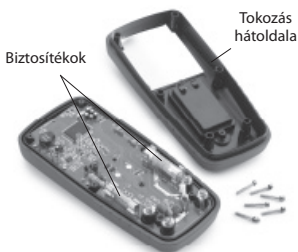
9. ábra – A multiméter tokozása hátoldalának levétele
