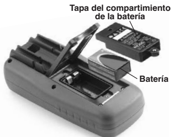
Figura 5 – Reemplazo de la batería
