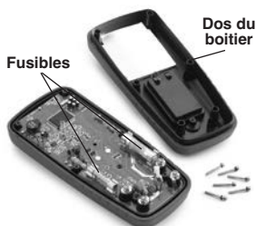
Figure 9 – Retrait du dos du boîtier
