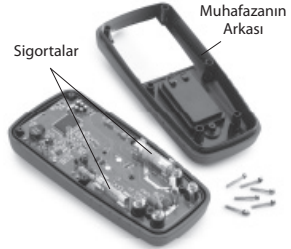
Şekil 9 – Multimetre Muhfazasının Arkasının Çıkartılması
