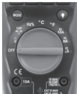
Slika 6 – Obrtni funkcijski prekidač
