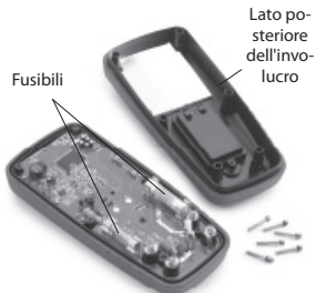
Figura 9 – Rimozione del retro dell'involucro del Multimetro
