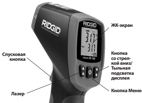
Рис. 8 – Дисплей и кнопки прибора micro IR-100
