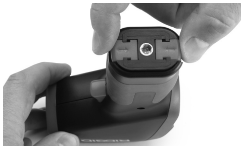
Рис. 4 – Извлечение держателя батарейки
