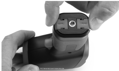
Figura 4 – Remoção do compartimento da pilha
