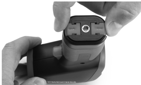
Rysunek 4 – Wyjmowanie komory baterii
