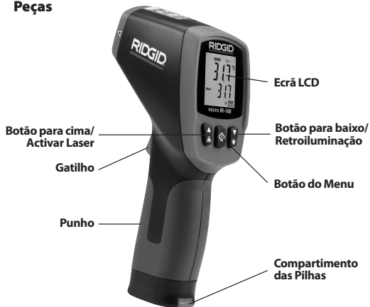
Figura 2 – Peças do micro IR-100
