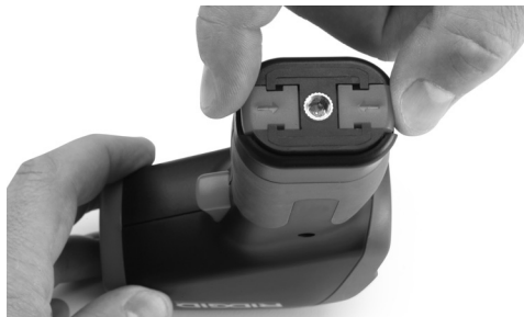
4. kép – Az elemtartó eltávolítása
