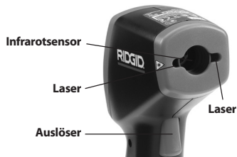
Abbildung 2 – Teile des micro IR-100
