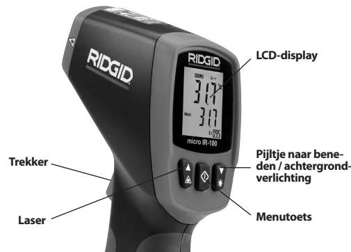
Figuur 8 – Display/Toetsen van de micro IR-100
