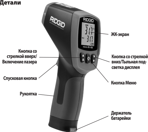
Рис. 2 – Детали прибора micro IR-100
