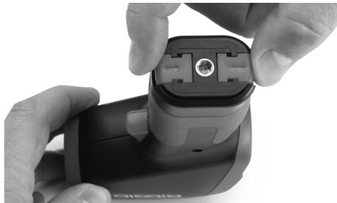
Abbildung 4 – Entfernen des Batteriefachs
