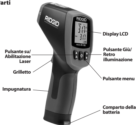
Figura 2 - Parti del micro IR-100
