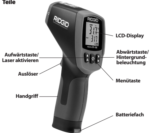
Abbildung 2 – Teile des micro IR-100
