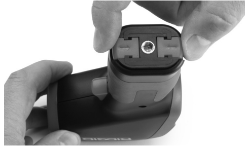
Şekil 4 – Pil Bölmesinin Çıkarılması
