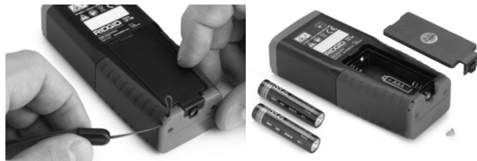
4. ábra – A tartókötel felszerelése 5. ábra – Elemcsere
