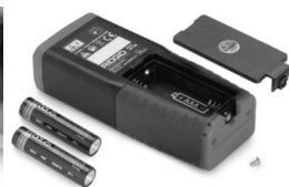
Rysunek 5 – Wymiana baterii
