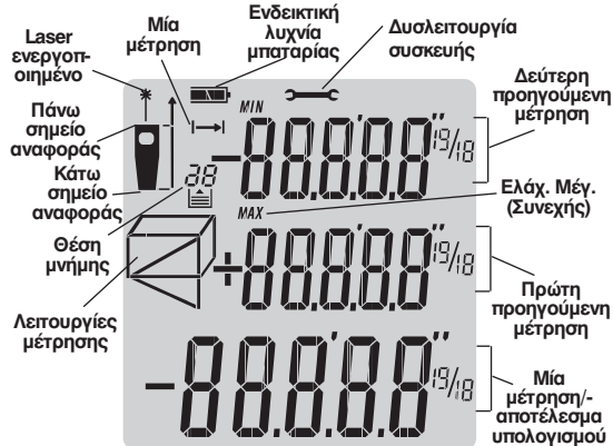
Εικόνα 3 – Η οθόνη LCD του micro LM-100
