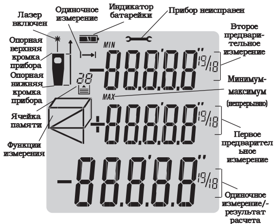
Рисунок 3 – ЖК дисплей прибора micro LM-100
