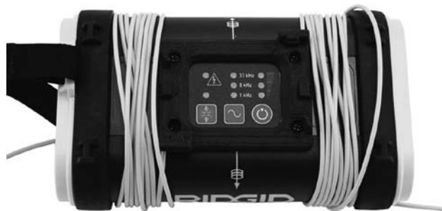
Fig. 11: ST-305 i induktiv funktionstilstand ved 33 kHz
