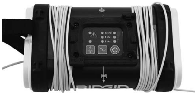
Figur 11: ST-305 i induktiv modus ved 33 kHz
