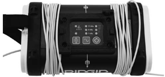
Figure 11: ST-305 en mode d'induction à 33 kHz
