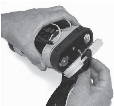
Figura 3: Rimozione del coperchio delle batterie
