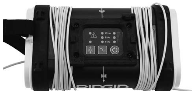
Figura 11: ST-305 no Modo de Indução a 33 kHz
