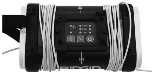
Figura 11: ST-305 in modalità induttiva a 33 kHz
