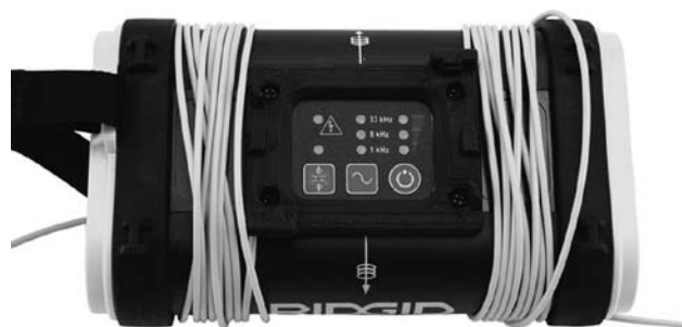
Figura 11: ST-305 en modo inductivo a 33 kHz
