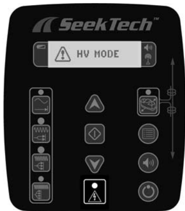
Figura 20: Indicador de Alta Tensão
