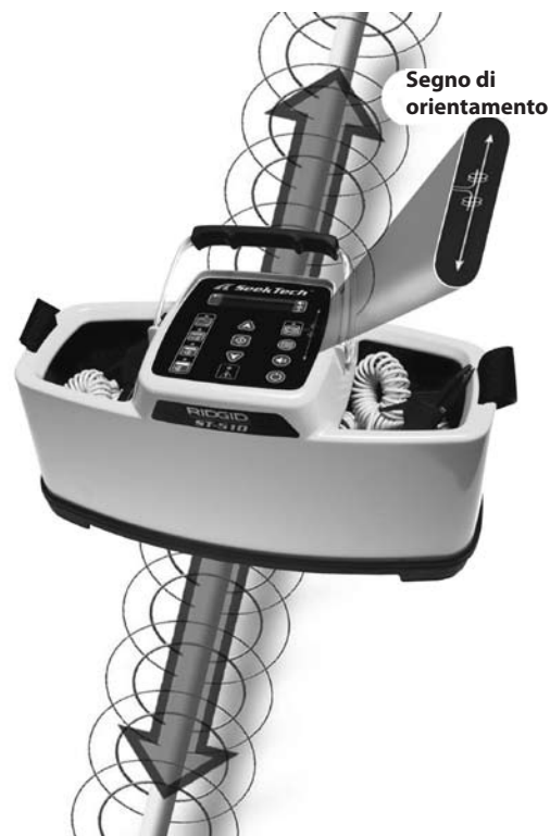
Figura 17: Orientamento rispetto al conduttore (Modalità induttiva)
