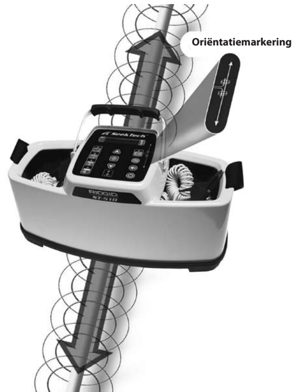
Figuur 17: Oriëntatie tot de geleider (inductieve modus)
