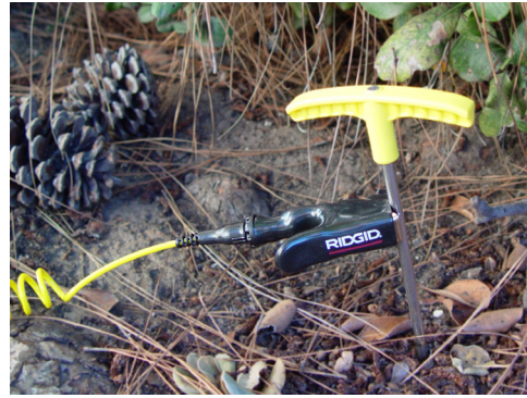
Рисунок 6 – Зажим подводящего провода, подсоединенный к заземляющему стержню
