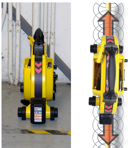
Рисунок 12 – Ориентировочные стрелки, выравненные вдоль проводника
