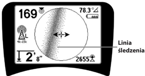
Rysunek 20: Linia śledzenia przedstawia duże zniekształcenie
