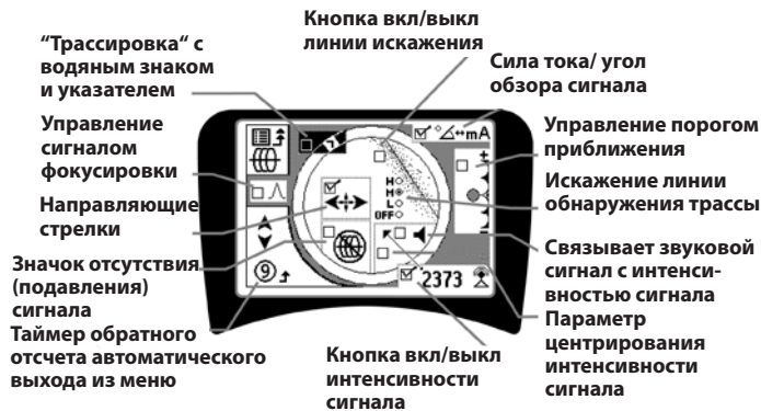
Рис. 32: Экранные элементы (режимы обнаружения трассы магистрали)
