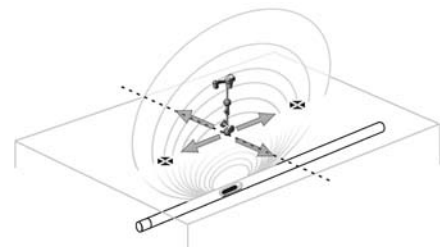
Abbildung 27: Pole und Äquator einer Sonde
