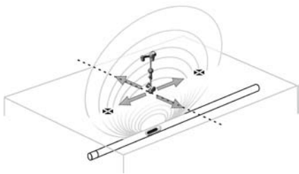
Figuur 27: polen en 0-lijn van een sonde
