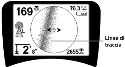
Figura 20: Linea di traccia che mostra un'alta distorsione
