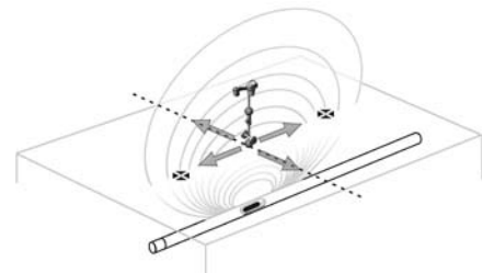
Figura 27: Polos y ecuador de una sonda.
