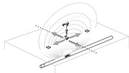
Figur 27: Poler og ekvator til en sonde
