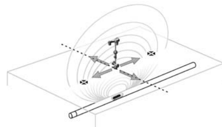
Figura 27: Poli ed equatore di una sonda
