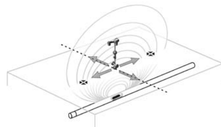
Fig. 27: En sondes poler og ækvator
