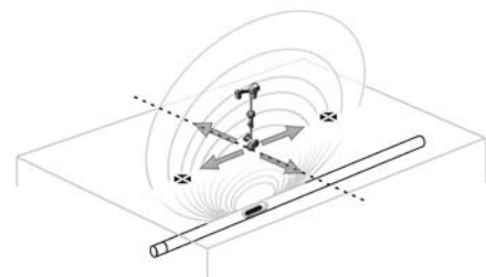
Рис. 27: Полюса и экватор зонда
