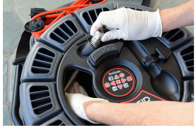
Рисунок 28 – Укладка головки камеры
