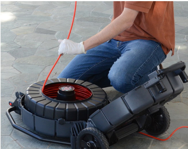
Рисунок 27 – Как направлять проталкивающий кабель в барабан
