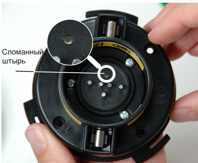
Рисунок 5 – Сломанный контактный штырь
