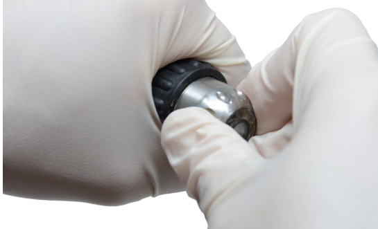
Рисунок 22 – Выкрутите камеру из пружины
