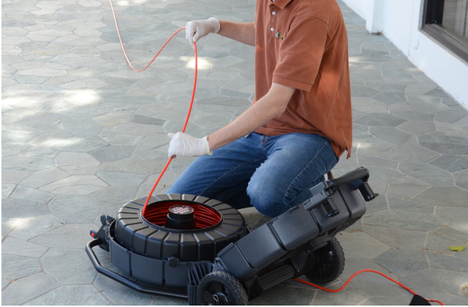
Рисунок 26 – Вращайте барабан, чтобы правильно намотать проталкивающий кабель
